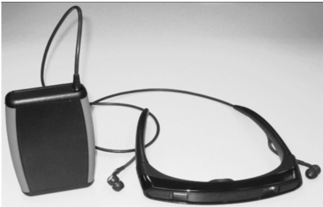
**Figura 3.** Óculos de RA - Óculos com tela LCD embutida nas lentes para o paciente visualizar as projeções apresentadas e com fones de ouvidos para transmitir os sons proporcionados. Projeções e sons são determinados e enviados através do sensor conectado a ambos, o qual ficara preso ao cinto. Espay (2010).
