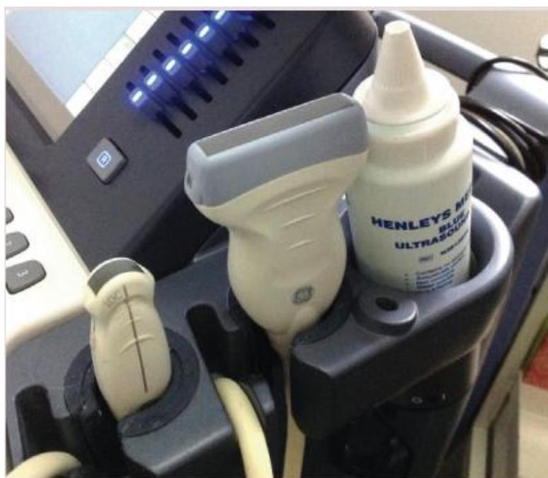
À esquerda, transdutor microconvexo, seguido do transdutor linear.
