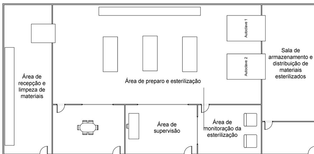
Figura 14 - Exemplo de um centro de materiais e esterilização e a posição relativa dos esterilizadores em relação à sala de supervisão.
