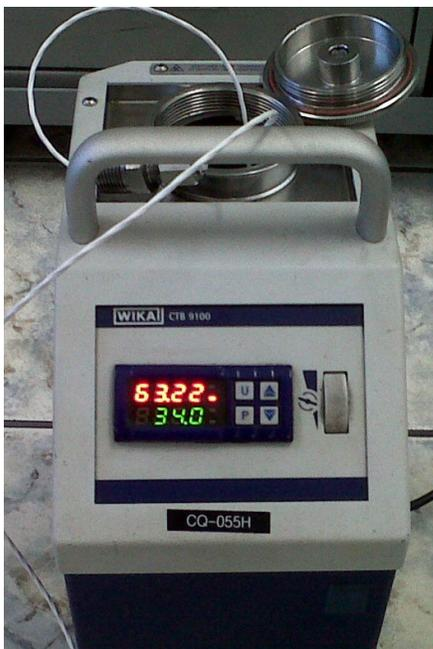
Figura 22 – Forno de calibração alcançando o primeiro patamar de calibração.
