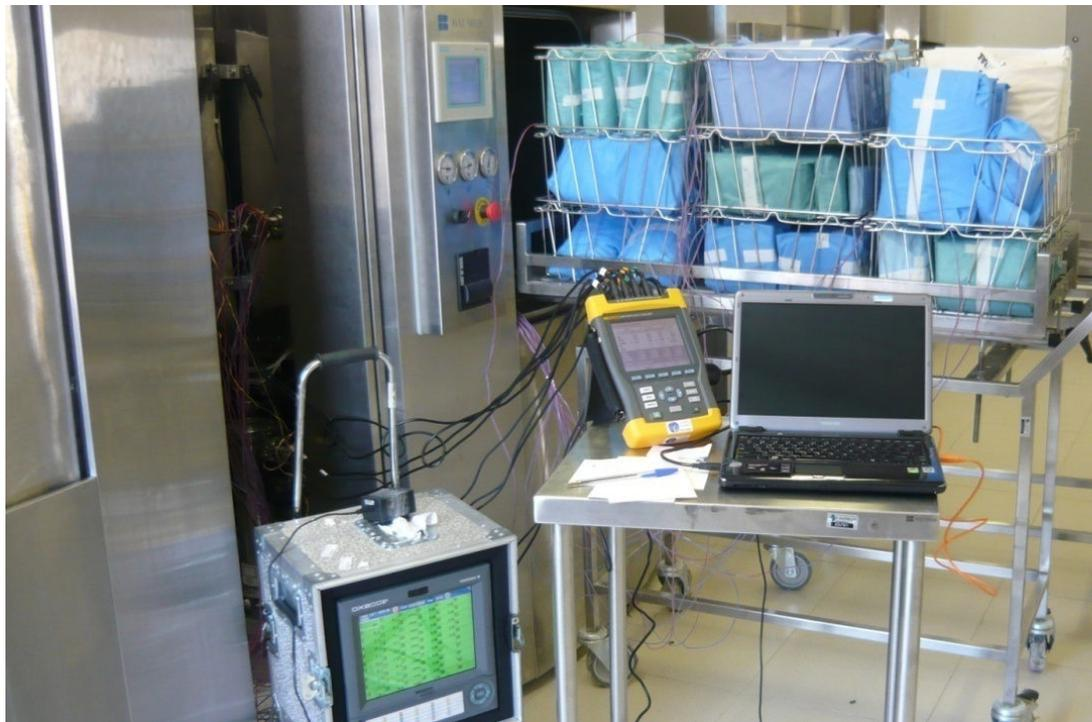
Figura 11 - Qualificação térmica realizada com *data logger* com fio.
