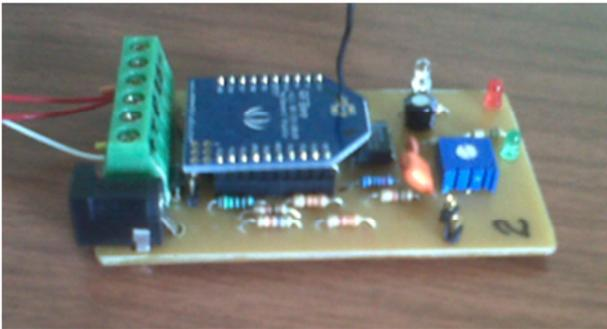
Figura 2 – Circuito sensor utilizado para aquisição de dados.
