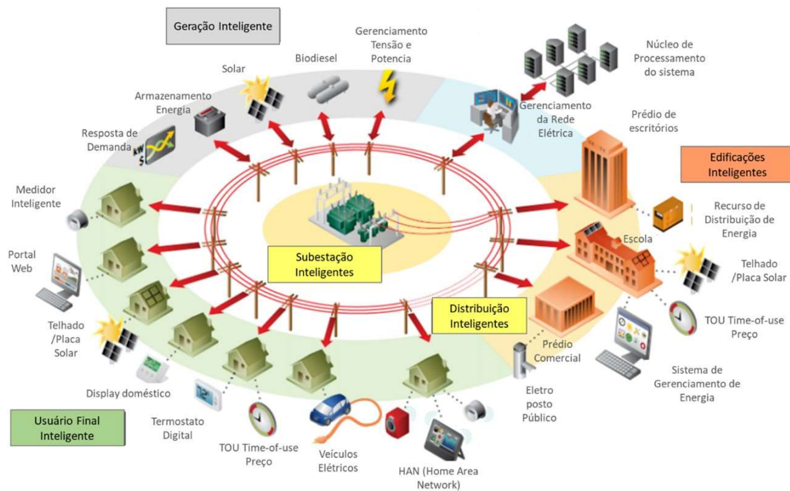
Figura 6 - Visão do futuro das redes elétricas inteligentes.
