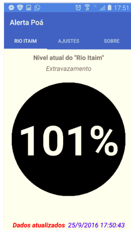
Figura 28. Estado de Extravazamento: Acima de 100% (Preta).
