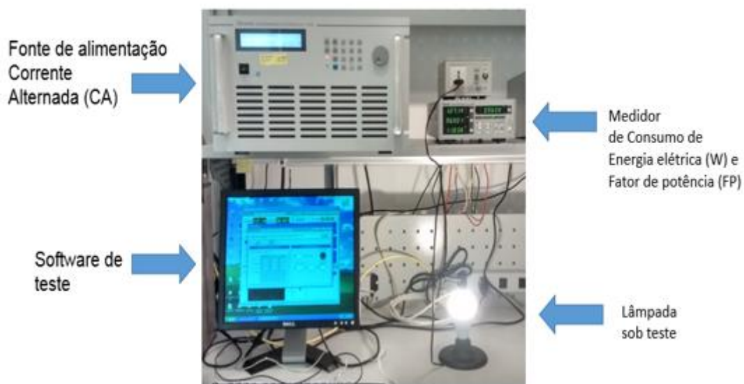
Figura 9 - Bancada de teste para medir consumo de energia elétrica e FP.
