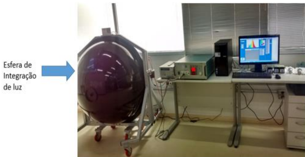
Figura 10 - Bancada de teste para medir fluxo luminoso e eficiência energética
