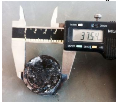
Figura 77 - Diâmetro do disco de carga utilizado
