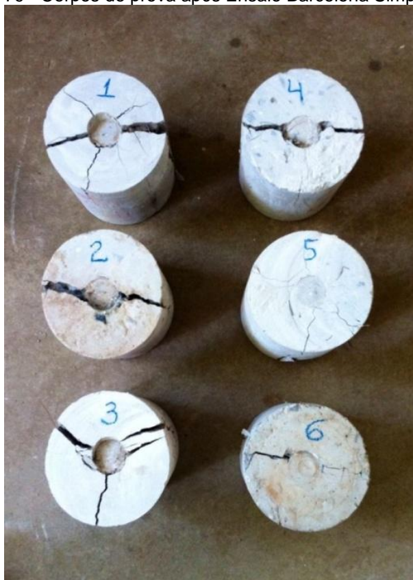
Figura 79 - Corpos de prova após Ensaio Barcelona Simplificado
