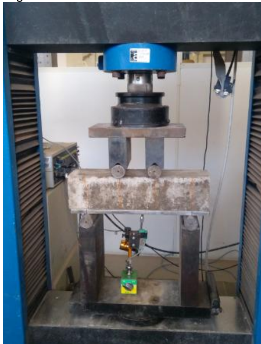
Figura 33 - Parte inicial do ensaio da C1399
