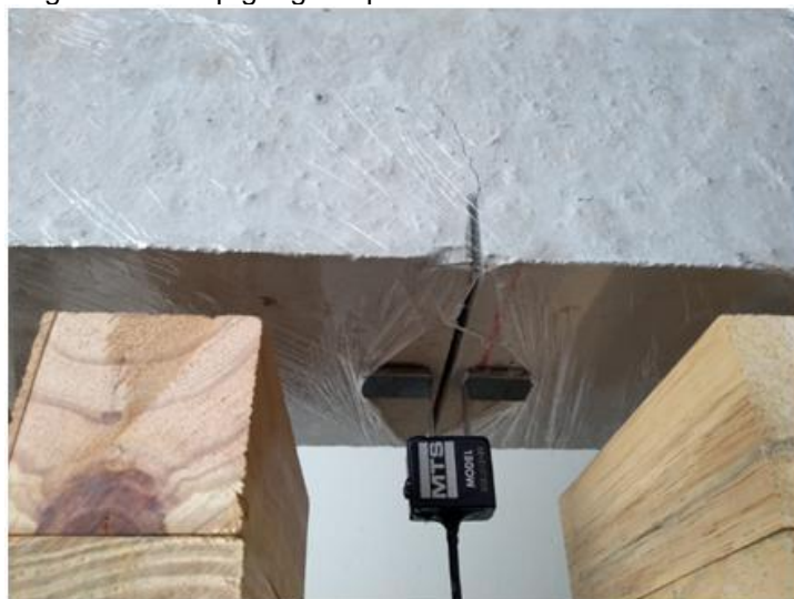
Figura 23 - "Clip gauge" e placas metálicas durante ensaio
