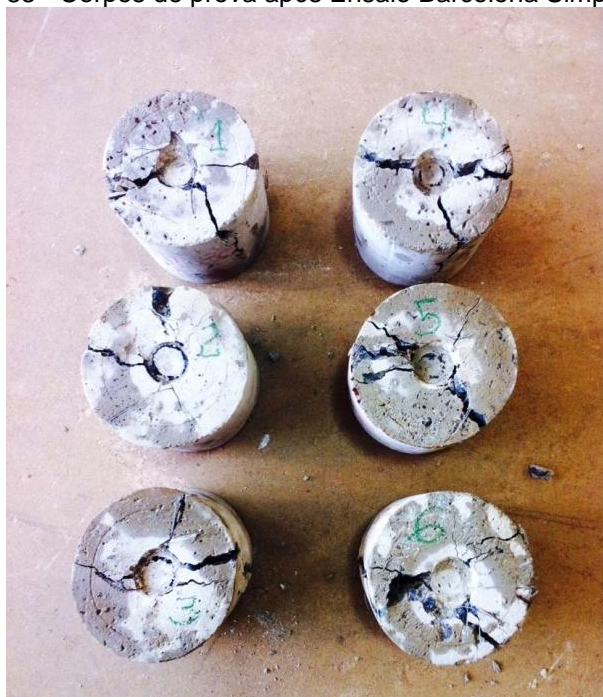
Figura 83 - Corpos de prova após Ensaio Barcelona Simplificado
