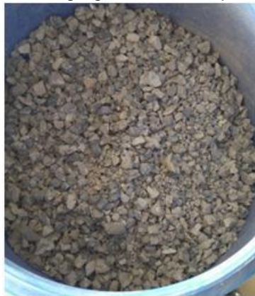
Figura 18 - Agregado reciclado produzido
