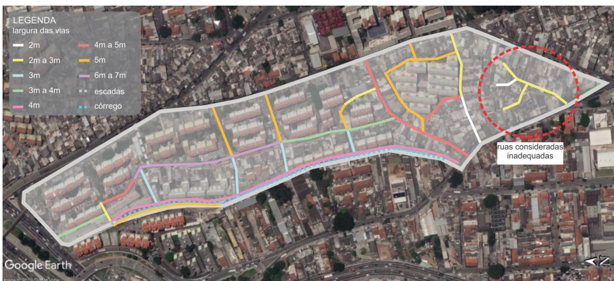
Figura 4.3 – Ruas inadequadas à implantação de infraestrutura e circulação. Fonte: elaboração própria sob foto aérea do Google Earth 2018.
