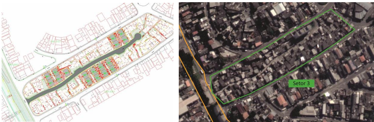
Figura 2.50 – Projeto de canalização e implantação de via para o córrego do setor 3 e foto aérea atual. Fonte: Projeto - GTA, 2004 / Foto aérea: elaboração própria sob foto aérea do Google Earth, 2018.
