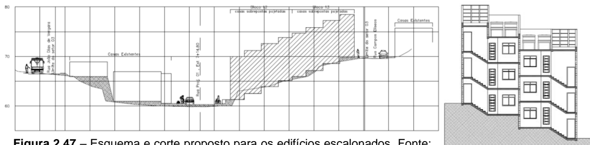
Figura 2.47 – Esquema e corte proposto para os edifícios escalonados. Fonte: PULHEZ, 2007.
