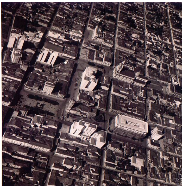
Foto aérea de Campinas em 1950 focalizando a área central com destaque para a rua Francisco Glicério com a irregularidade dos alinhamentos com trechos modernos já alargados e outros antigos, ainda estreitos.
