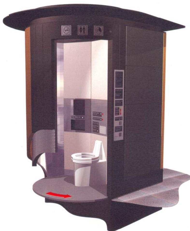
O interior do Sanitário Público Automático Compacto tem 1 metro quadrado de área de piso e 2,2 metros de altura. A pia e o secador combinados são estilizados em aço inoxidável, com os acessórios adicionais incluindo um extrator automático de papéis, recipiente para papéis usados e gancho para casaco. As paredes são construídas em painéis texturizados de aço inoxidável e poliéster. O piso de alumínio é coberto por vinil antiderrapante.
