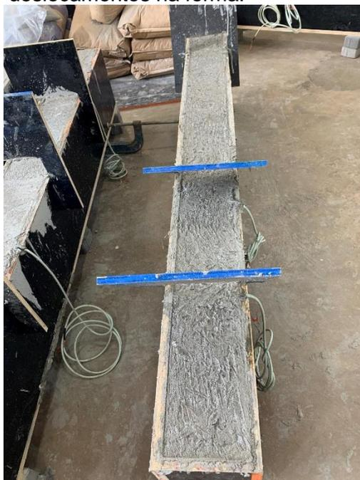
Após as moldagens, as vigas foram curadas durante 28 dias antes da realização dos ensaios de flexão a quatro pontos. No procedimento de cura, para
