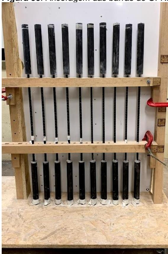
Os tubos metálicos foram preenchidos com argamassa expansiva, de marca Splitstar. A argamassa expansiva é um material pulverulento, e para o seu uso deve ser misturado água na proporção de 30% da massa utilizada (exemplo: 1500ml de água para 5000g de argamassa). O preenchimento dos tubos é realizado com a argamassa em estado líquido.
