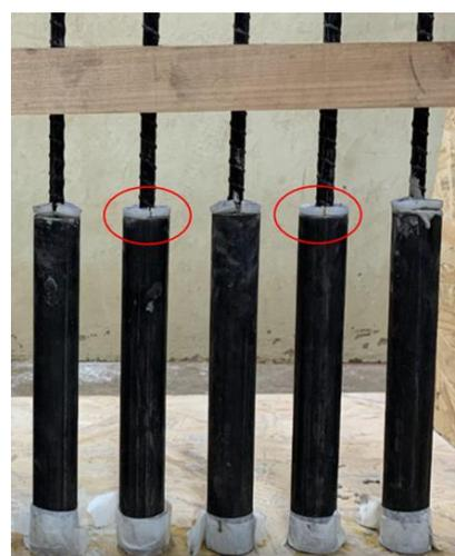
O ensaio de tração direta foi realizado na prensa hidráulica Emic DL30000F. A Figura 36a ilustra a barra de GFRP posicionada para o ensaio de tração. O extensômetro utilizado para medir a deformação da barra ao longo do ensaio foi o
