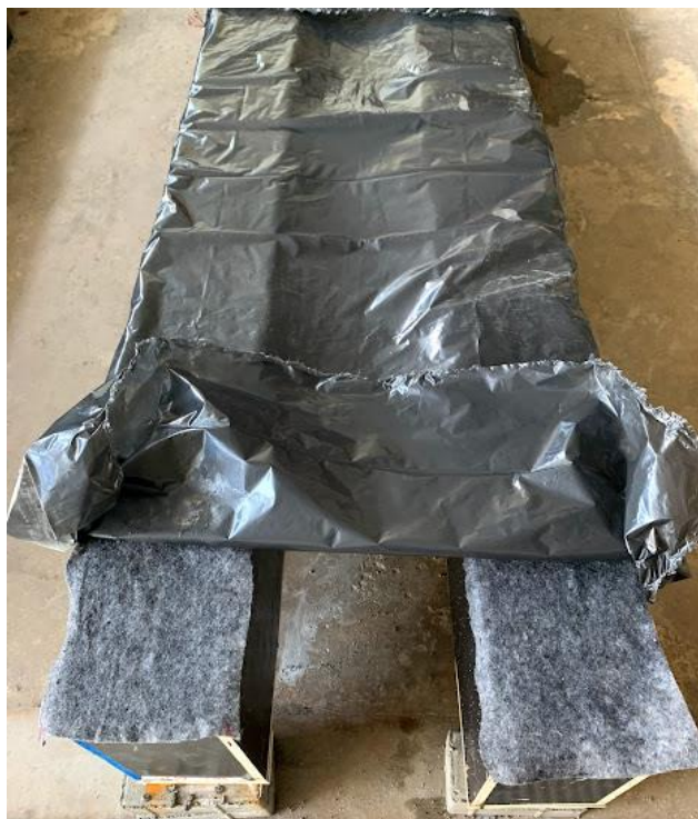
Figura 34. Processo de cura das vigas.
