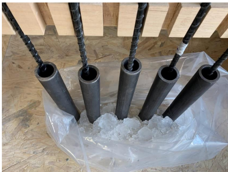
Figura 24. Gelo ao redor dos tubos.
