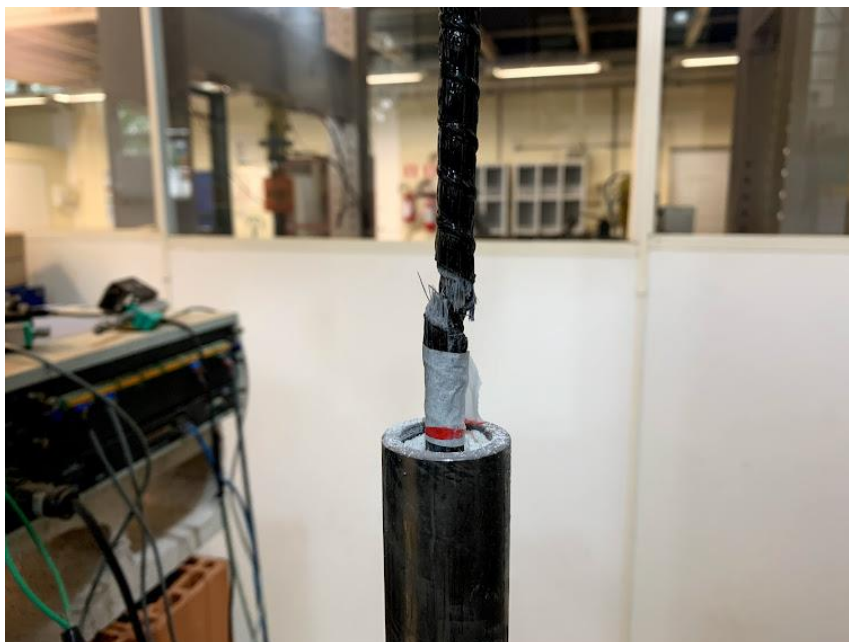
Figura 45. Ruptura da barra de BFRP.
