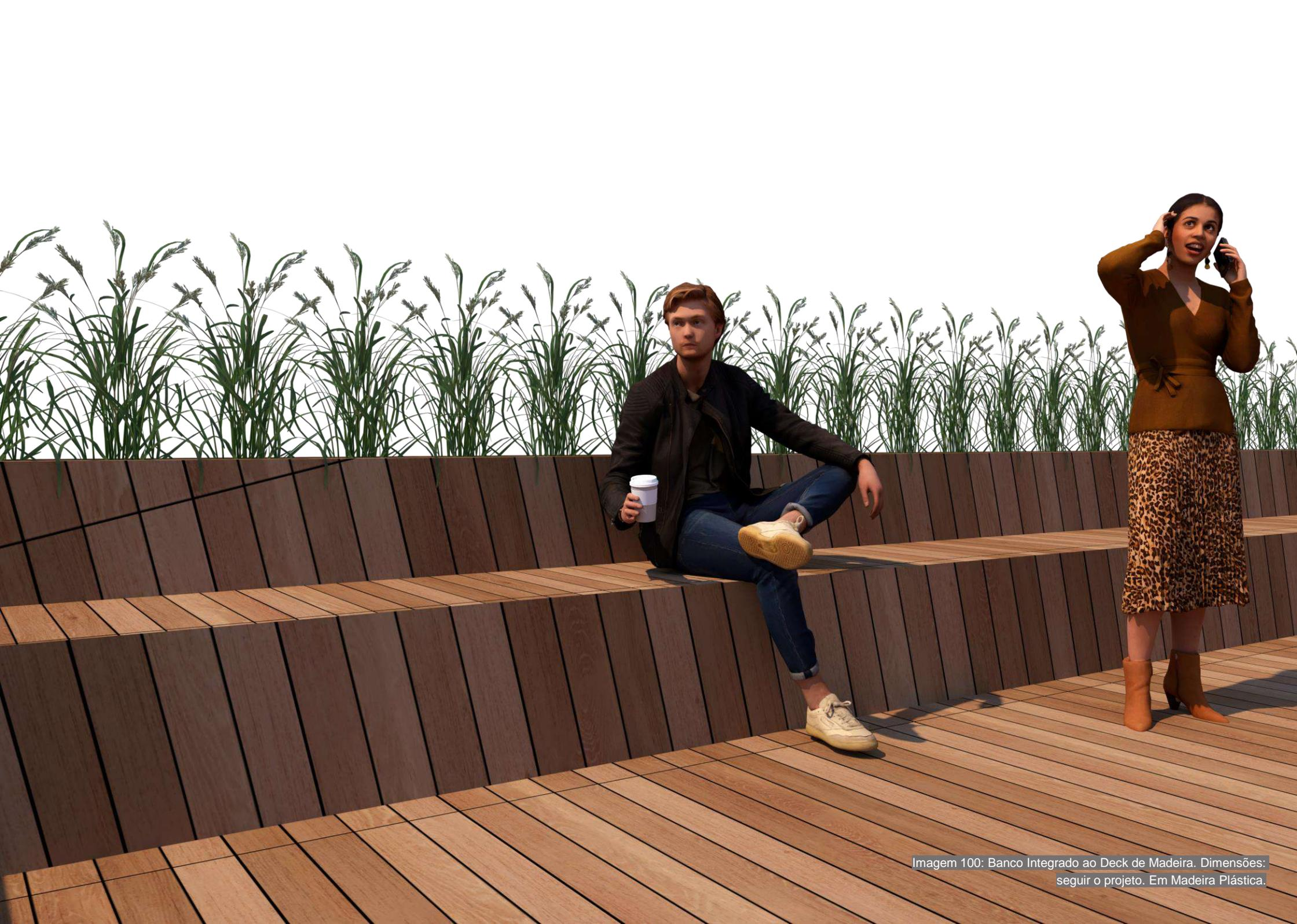
Imagem 100: Banco Integrado ao Deck de Madeira. Dimensões: seguir o projeto. Em Madeira Plástica.
