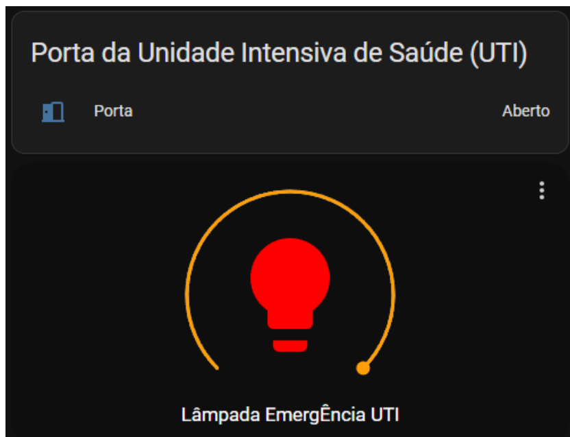
Figura 59 - Estado do sensor de abertura e lâmpada de emergência com a porta aberta Fonte: Autoria Própria, 2023
