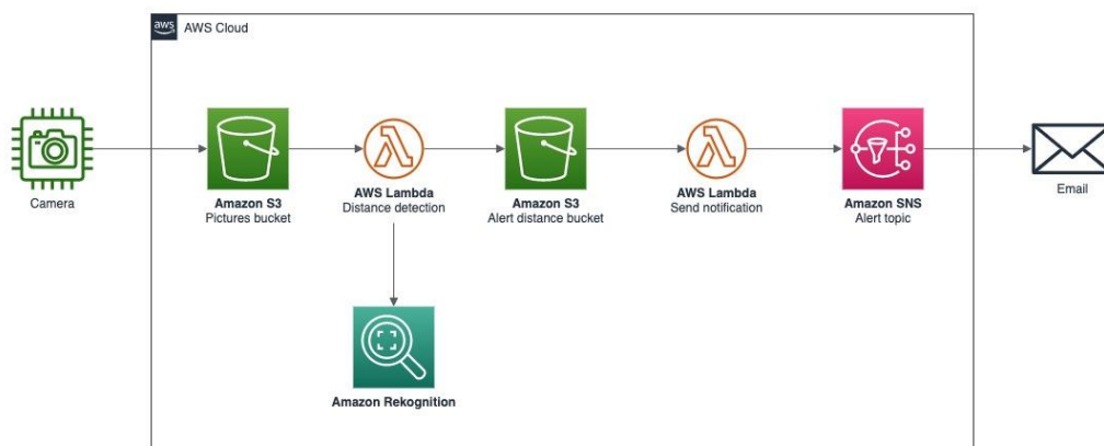
Figura 12 - Exemplo de Arquitetura de uma solução utilizando Amazon
