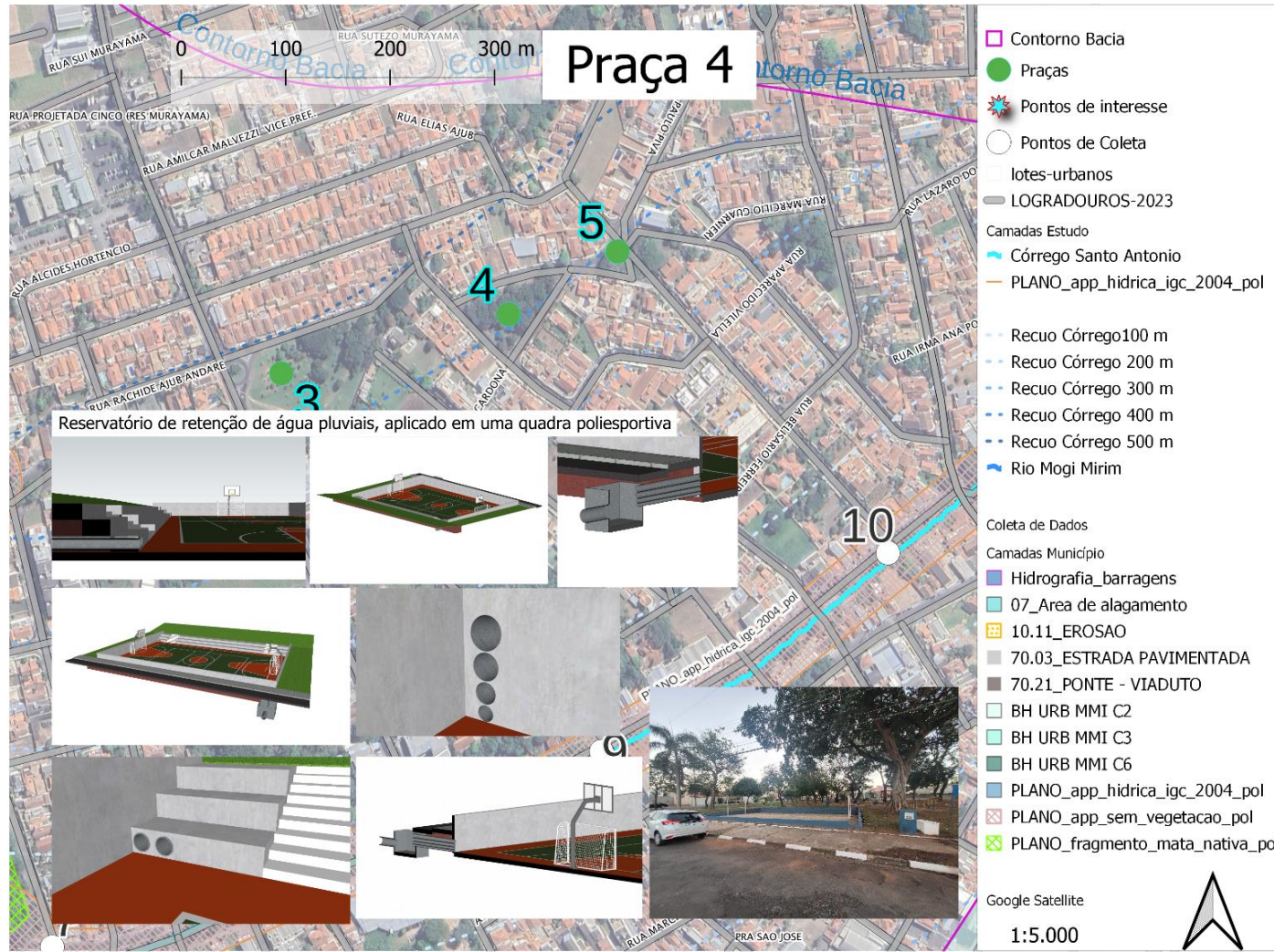
Figura 45. Praça 4 - Reservatório de retenção de águas pluviais, aplicado em uma quadra poliesportiva.
