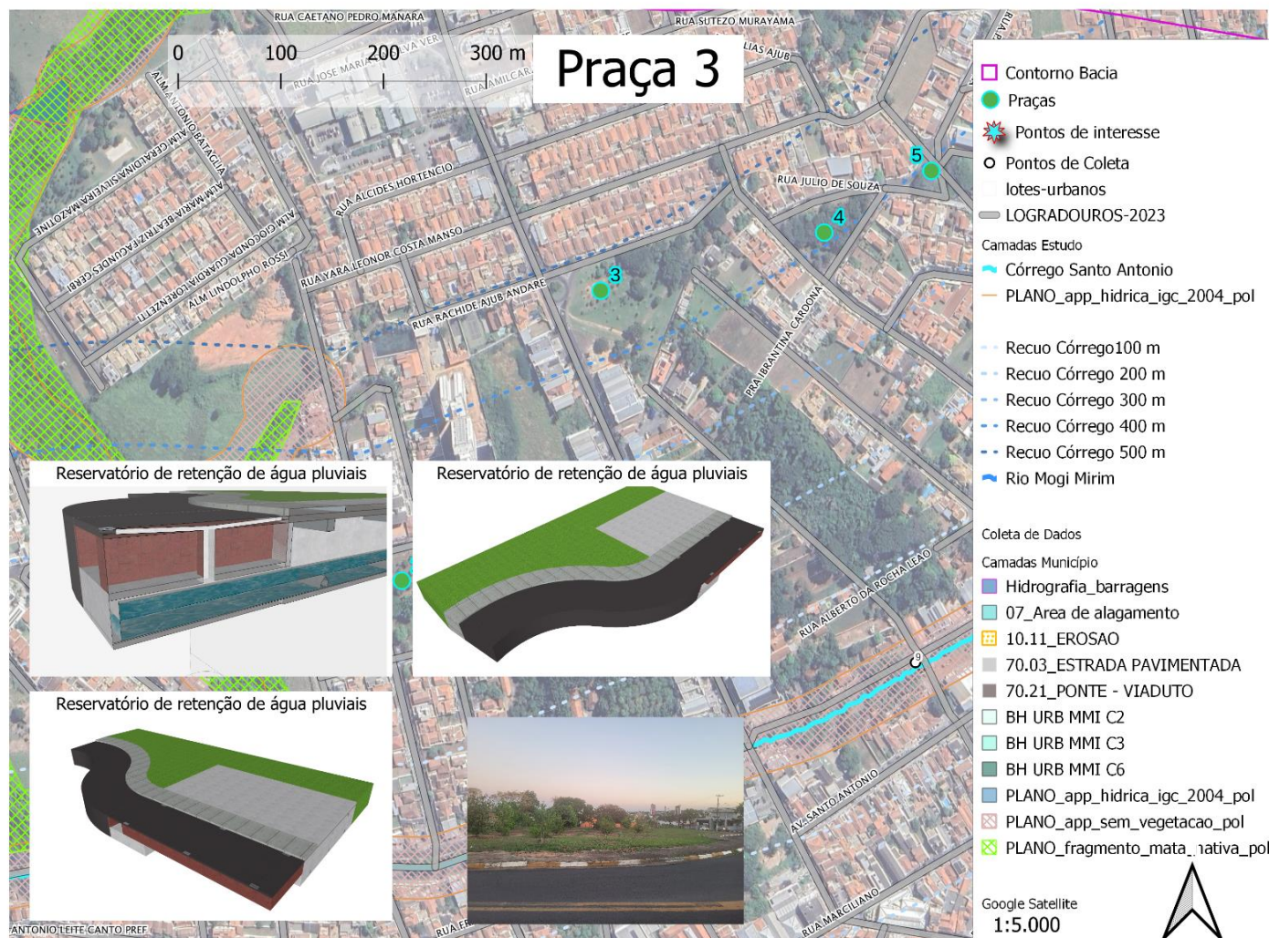
Figura 44. Praça 3 - Reservatório de retenção de águas pluviais.
