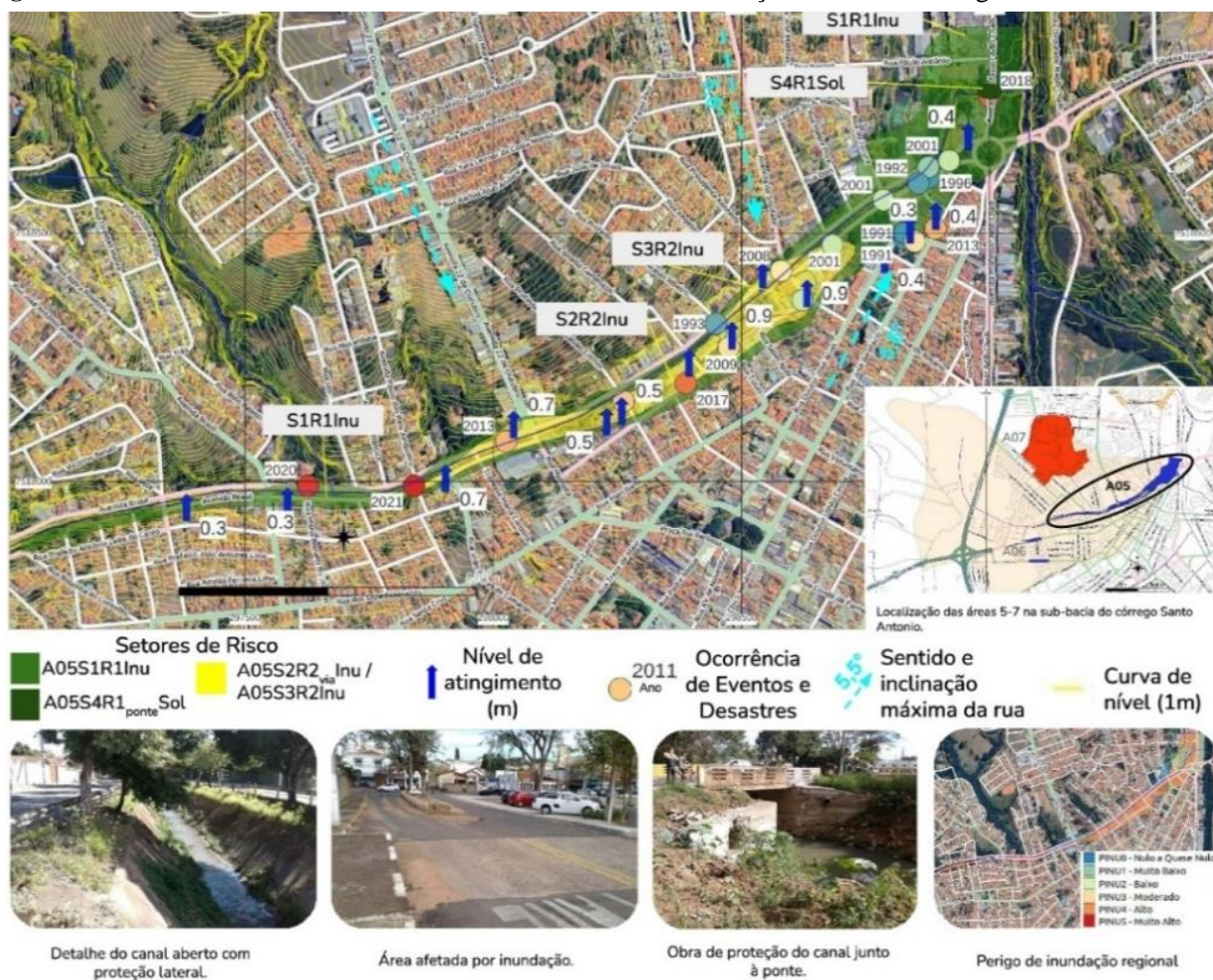
Figura 26. Carta de risco de áreas de uso residencial/comercial/serviços aos fenômenos geodinâmicos na escala 1:2.000 de Mogi Mirim.
