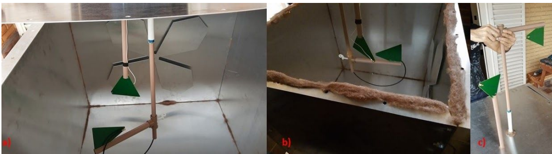
Imagem 02 - Montagem da câmara de reverberação
