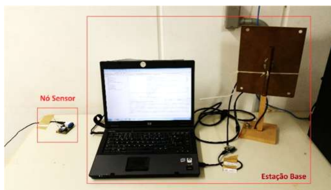
Figura 32: Foto do Ambiente de Teste - Composição da Estação Base e Nó Sensor
