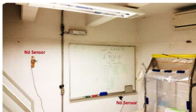
Figura 36: Foto do Ambiente de Teste – Distribuição dos NS no Piso 2, parte B
