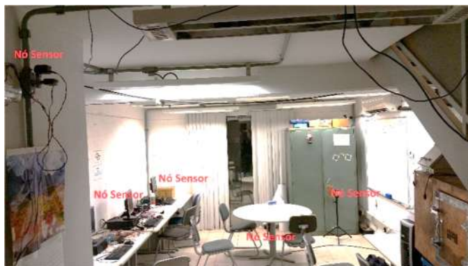
Figura 33: Foto do Ambiente de Teste – Distribuição dos Nós Sensores no Piso 1
