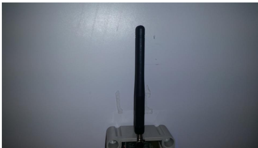
Figura 6 - Antena monopolo vertical
