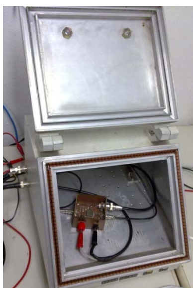
Figura 24 - Atenuador variável dentro da Caixa Blindada
