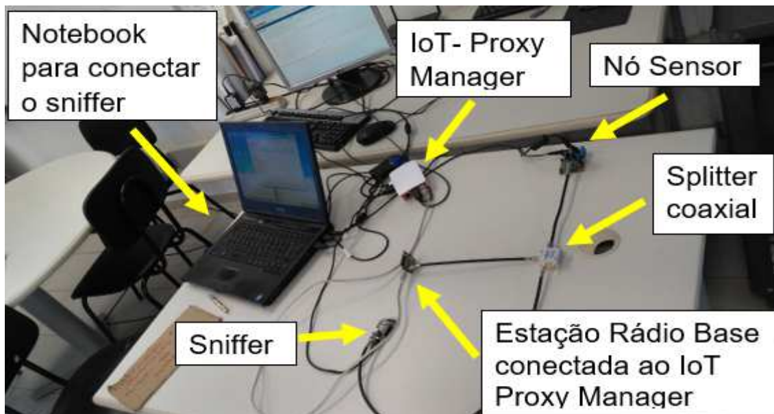
Figura 22 - Bancada de emulação criada para os experimentos
