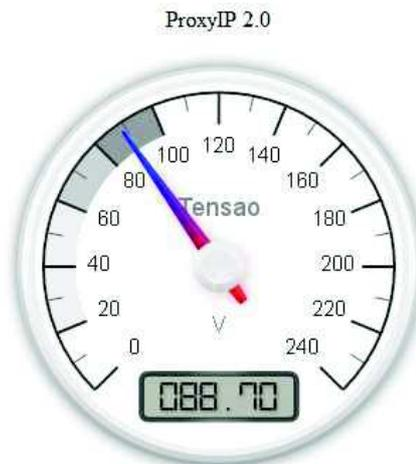
**ALARME: Afundamento Temporario de Tensao**
