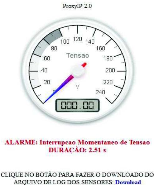
Na sexta e última etapa de simulação, foi efetuada a detecção da Interrupção Temporária de Tensão, onde, por 10 segundos interrompeu-se a aplicação de tensão aos terminais do instrumento FLUKE 435.
