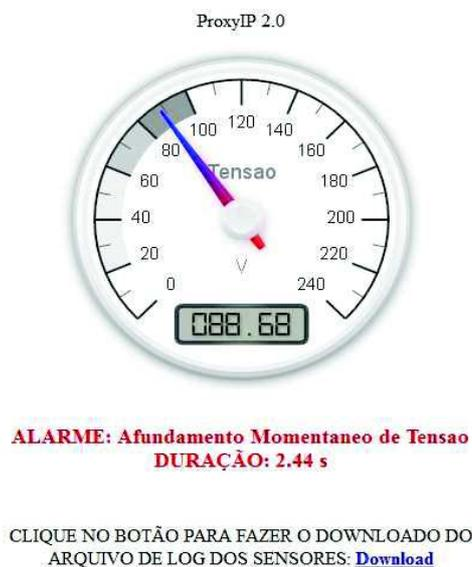
A segunda simulação efetuada foi para a detecção do afundamento temporário de tensão, onde por 5 segundos provocou-se um afundamento com o valor de 88,9 Volts e após este intervalo, voltou-se a aplicar à tensão de 127 Volts aos terminais do instrumento FLUKE 435.
