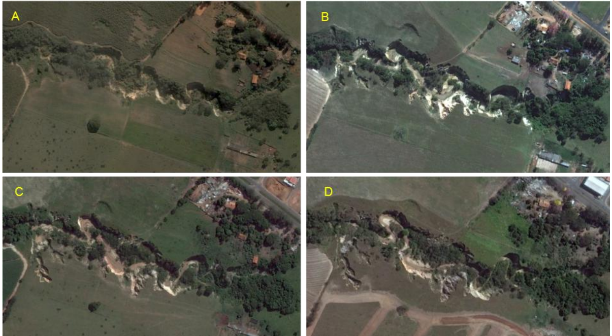
Figura 12: Histórico do processo erosivo, localizado no córrego Suzigan - Santa Bárbara d'Oeste A: 20/05/2004, B: 23/07/2010, C: 20/04/2014, D: 27/08/2017).
