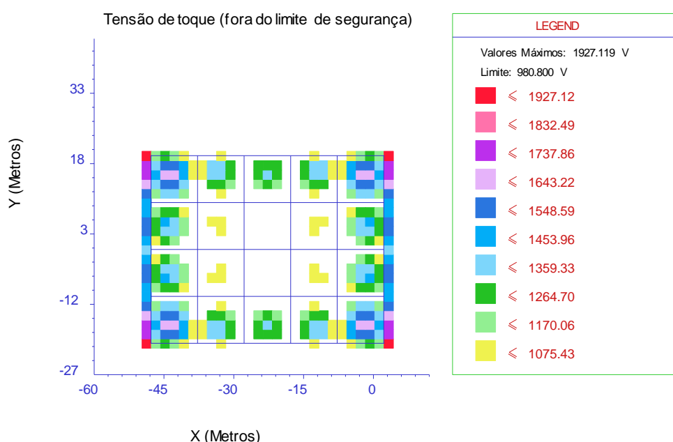
Figura 60 – Tensão de passo do terreno de Guariba fora de segurança (malha referência com envelopamento 3, com recobrimento de brita)
