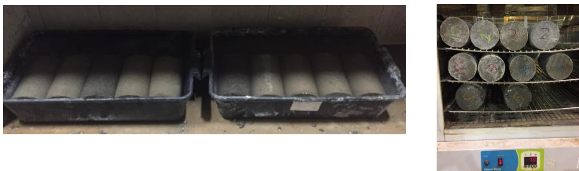
Figura 10 – Corpos de prova sendo ensaiados por capilaridade
