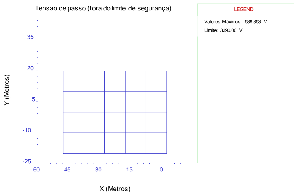
Figura 60 – Tensão de passo do terreno de Guariba fora de segurança (malha referência com envelopamento 3, com recobrimento de brita)
