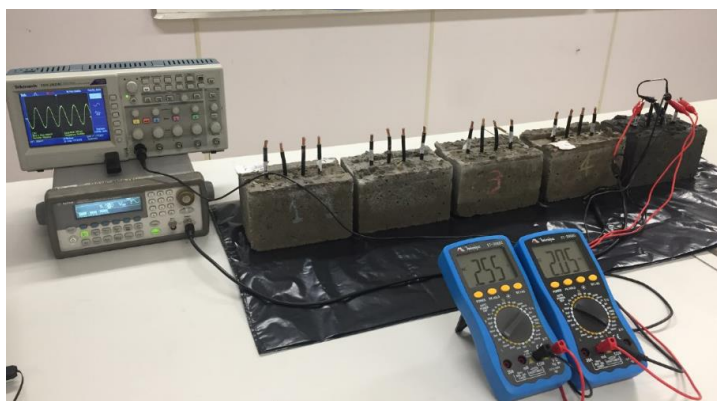
Figura 16 – Procedimento de medição para o ensaio de resistividade elétrica
