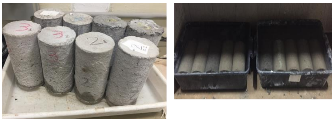
Figura 10 – Corpos de prova sendo ensaiados por capilaridade
