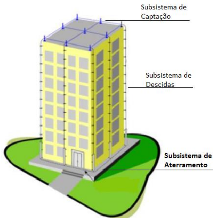
Figura 1 – Subsistemas do SPDA
