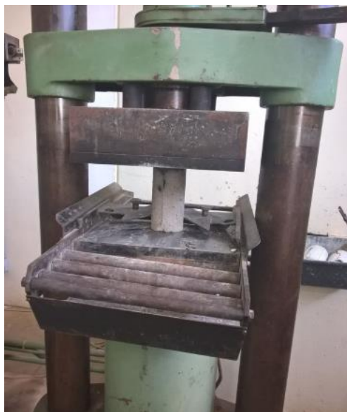
Figura 11 – Prensa utilizada para o ensaio de resistência a compressão axial
