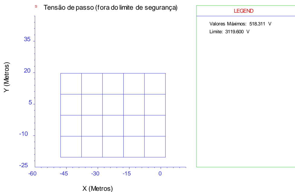
Figura 54 – Tensão de passo do terreno de Guariba fora de segurança (malha referência com recobrimento de brita)
