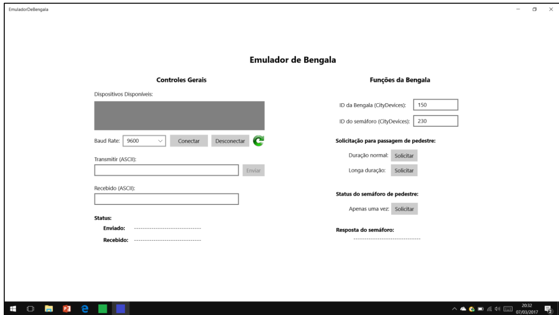
Figura 15. Emulador de bengala inteligente. Fonte: Produzida pelo autor.
