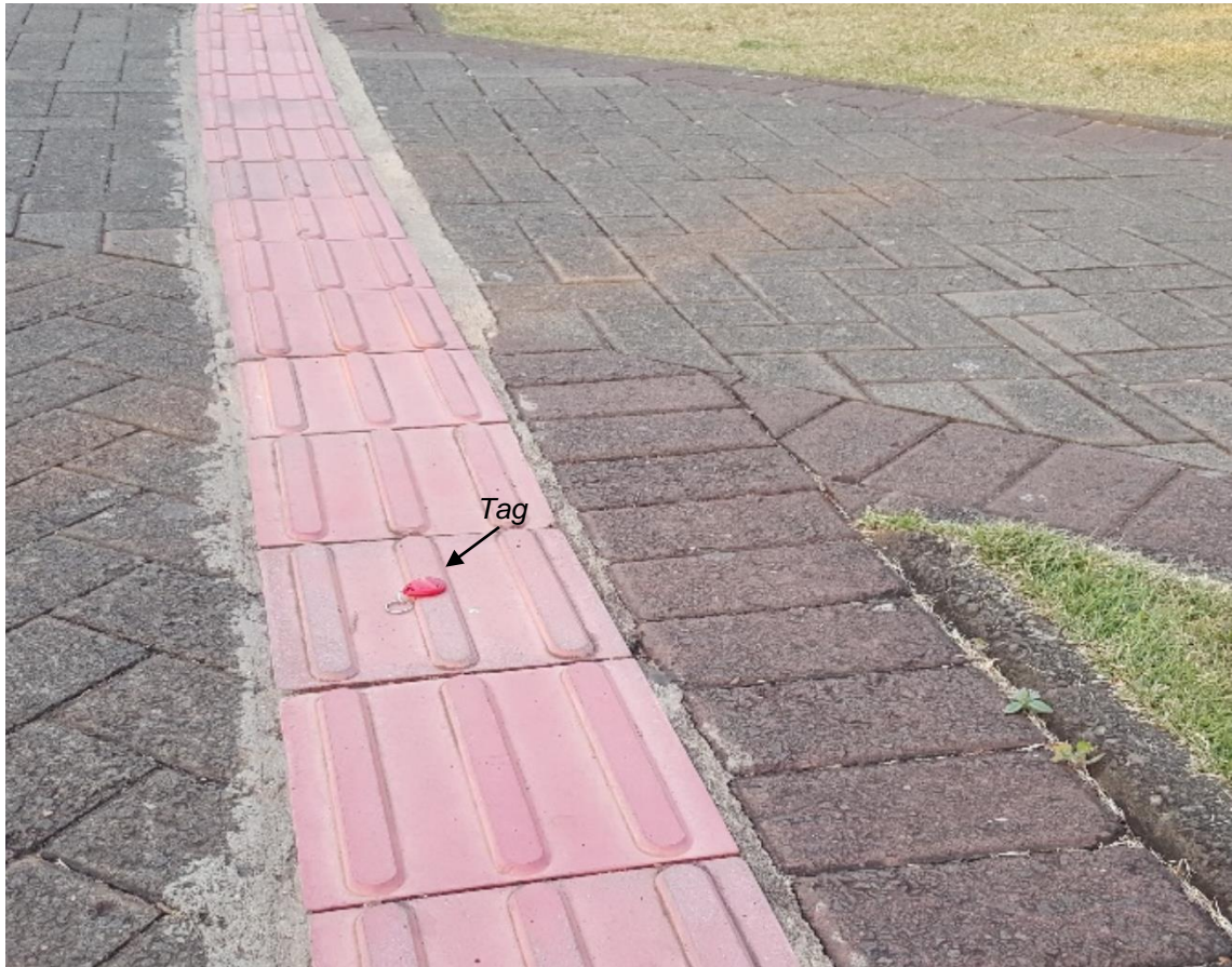
Figura 39. Tag de teste no piso tátil. Fonte: Produzida pelo autor.
