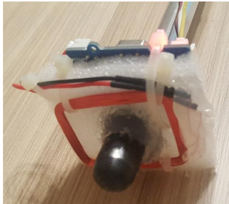
Figura 9. Leitor de RFID na ponta da bengala (vista de frente). Fonte: Produzida pelo autor.
