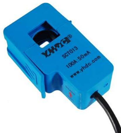
Figura 10 – Transformador de Corrente SCT-013
