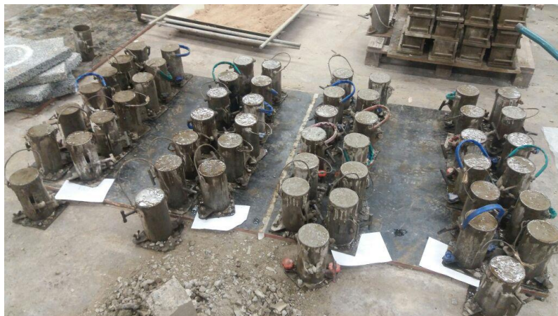
Figura 5.29 - Organização de corpos de prova.
