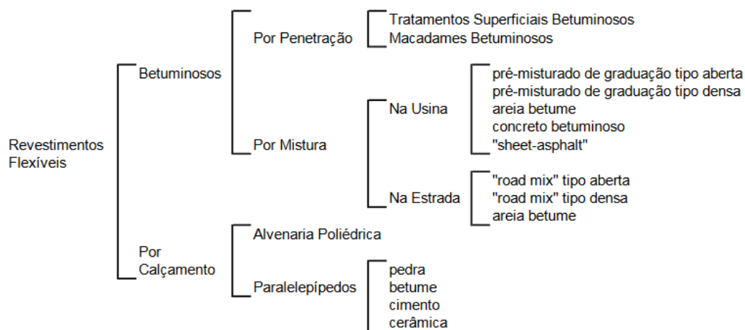
Figura 3.10 - Tipo de Revestimentos asfálticos
