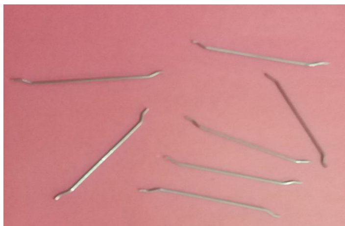
Figura 5.34 - Fibras de aço.
