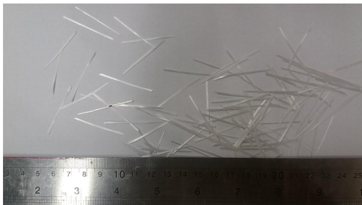
Figura 5.35 - Fibras de vidro.
