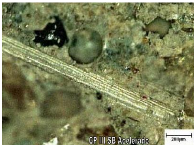
Figura 2.9 - Fotografia de microscopia de matriz cimentícias com fibras de vidro.
