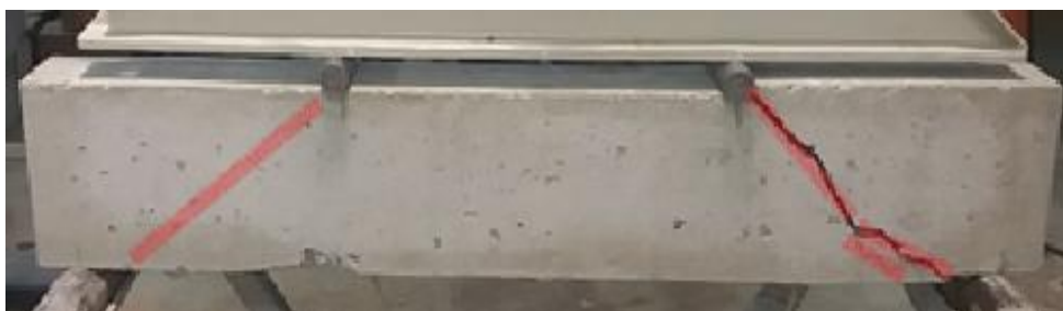
Figura 6.83 – TREF SE – detalhes fissuras
