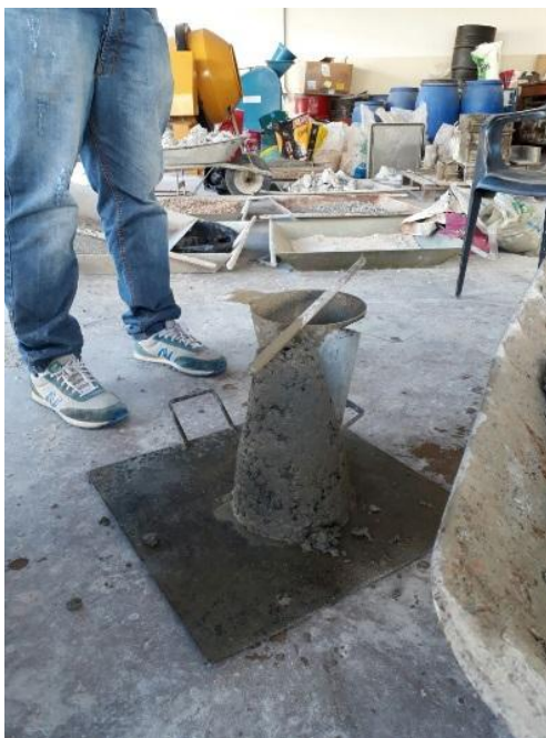
Figura 5.32 - Verificação de abatimento por meio de Slump Test.
