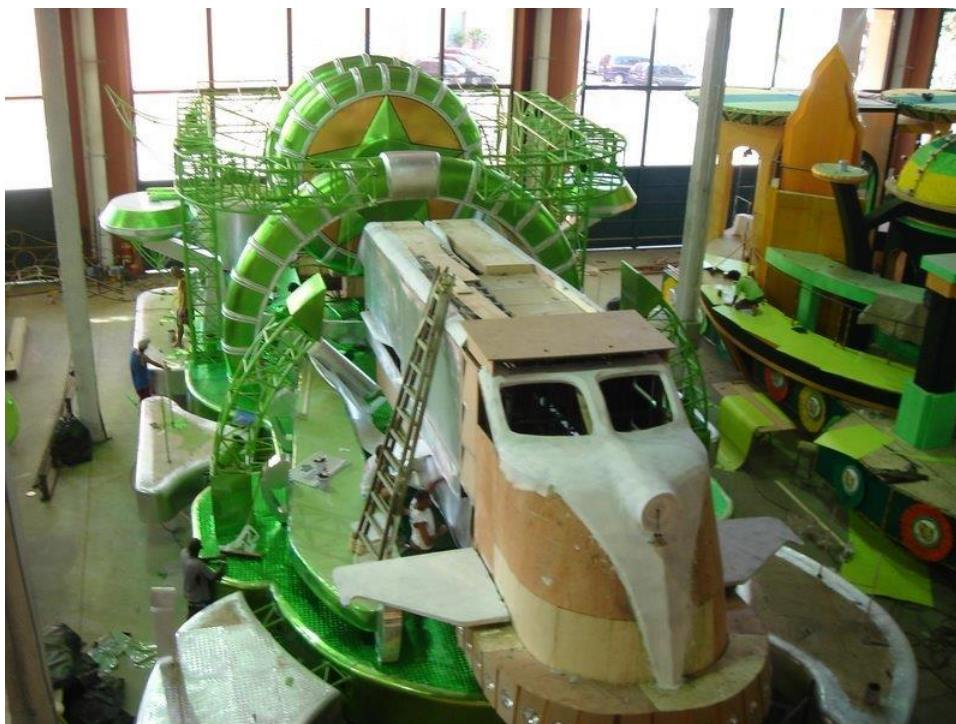
Figura 6 – O carro alegórico começa a ser decorado com os adereços enquanto é forrado e pintado.
