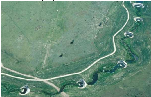
Figura 68 - Sucessão de Reservatórios do projeto Shop Creek
