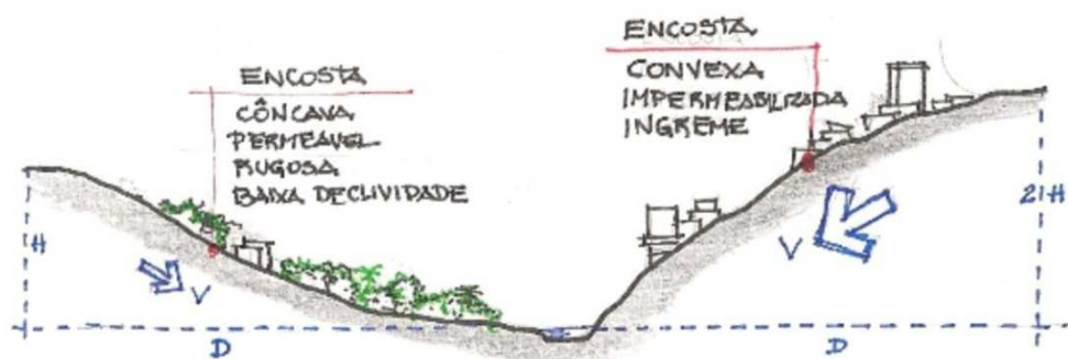
Figura 8 - Escoamento superficial em função das características das encostas
