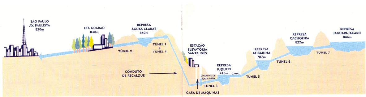
Figura 20 : Perfil do esquema de represas do Sistema Cantareira
