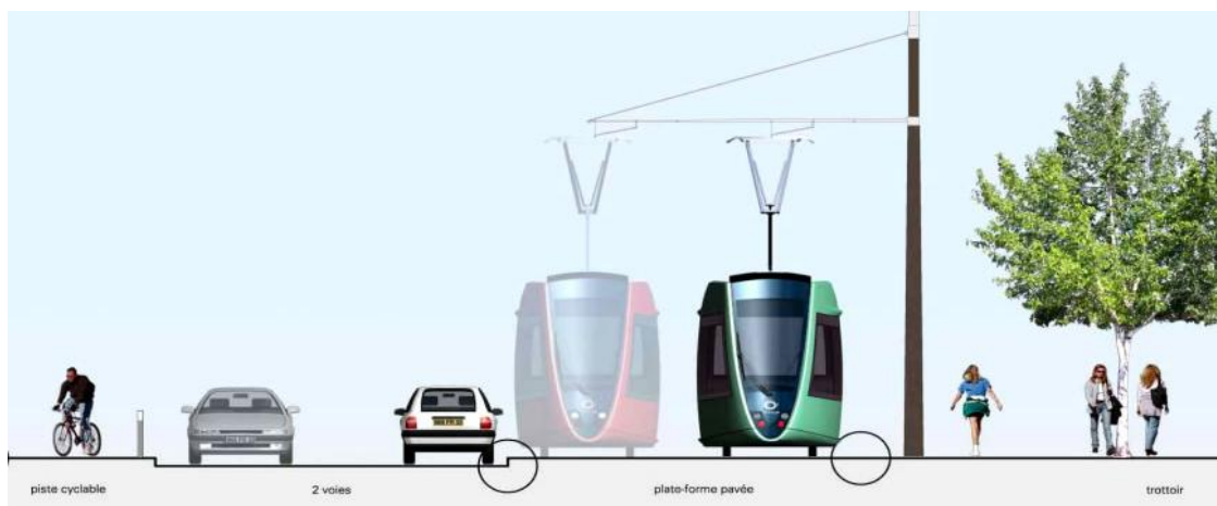
Fig. 08 – Corte esquemático do sistema VLT. Disponível em: www.tramvia.org Acessado em: 20 Out. 2009
