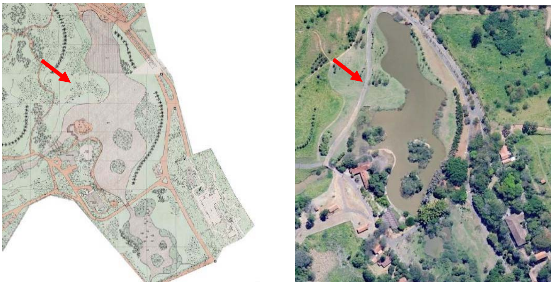
Figura 45 - 5 – Área do Lago: o lago se encontra idêntico ao proposto. O desenho da vegetação parece ter sido executado como proposto, porém percebem-se falhas no desenho (prováveis mudas mortas que não foram repostas). O atual caminho principal (seta) foi modificado. Projeto original fornecido pelo Escritório Burle Marx e foto aérea obtida no Google Earth em 05 de novembro de 2015.
