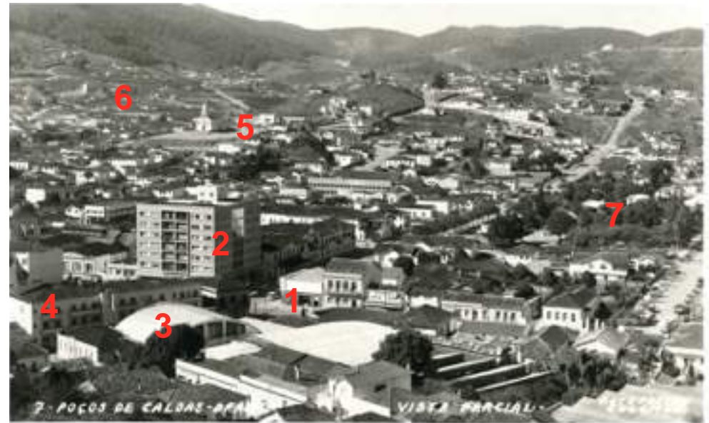
Figura 09: Vista parcial da área central de Poços de Caldas em c.1950. A imagem, posicionada de oeste para leste mostra o adensamento da área central e a ocupação dos lotes não mais respeitando o Plano de 1872 com dimensões de 10mx50m e sim lembrados e desmembrados. Predominam construções sem recuos frontais e laterais. Em destaque: 1.Rua Assis Figueiredo; 2, 3 e 4 Lotes membrados para implantação de edifício comercial em residencial. 2: Galpão de produção de sabonetes com água termal em 3. 4:Hotel . 5: Morro do Itororó; 6: Loteamento Jardim dos Estados, localizado à nordeste da área central. 7: Balneário dos Macacos. Acervo: Foto Postal Colombo. Fonte: Museu Histórico e Geográfico de Poços de Caldas.
