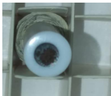
Figura 3. Fotografia do eletrodo de carbono vítreo após modificação da superfície pela adição de nanopartículas funcionalizadas com quitosana e anticorpos.
