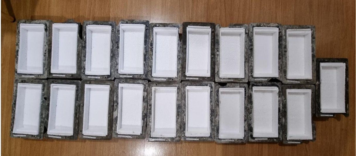
Figura 6 – Recipientes com suas paredes revestidas de poliestireno expandido utilizados para acondicionar as amostras.
