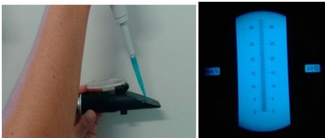
Figura 2. Refratômetro de brix óptico (esquerda) e escala interna do refratômetro, onde se avalia a qualidade do colostro (direita).
