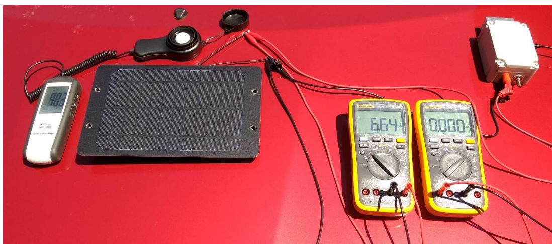
Figura 46 – Arranjo Experimental para Levantamento de Curvas I-V e P-V dos Painéis (Luz Solar).
