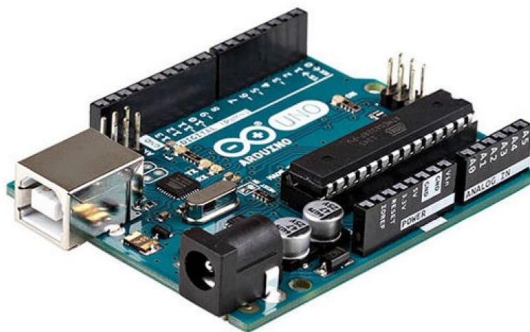
Figura 12 – Arduino Uno R3
