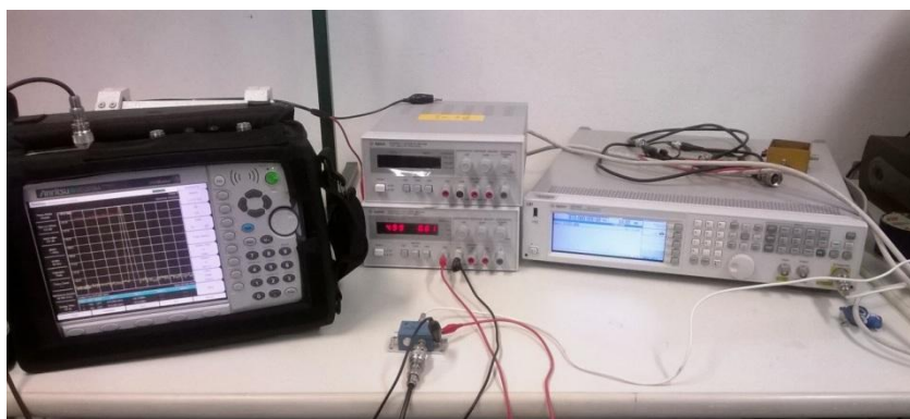
Figura 25: Bancada de teste com chave de RF.
