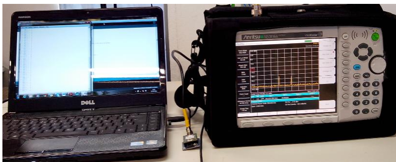
Figura 28: Setup para verificar a potência dos rádios.
