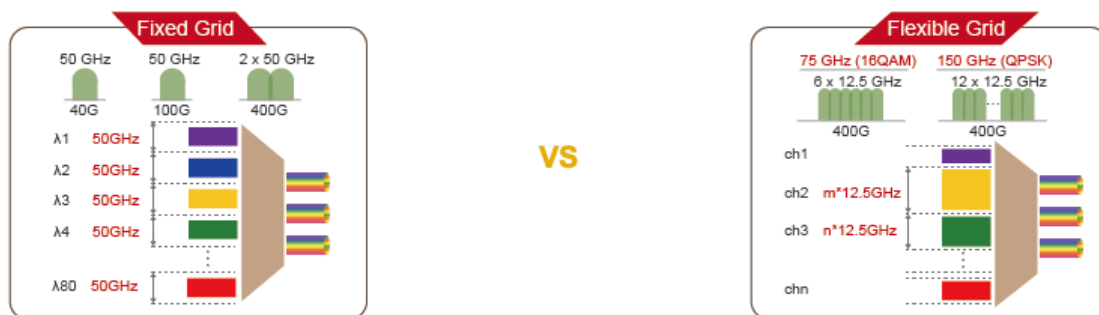
Figura 15 - Restrição de contiguidade na alocação de superchannels.
