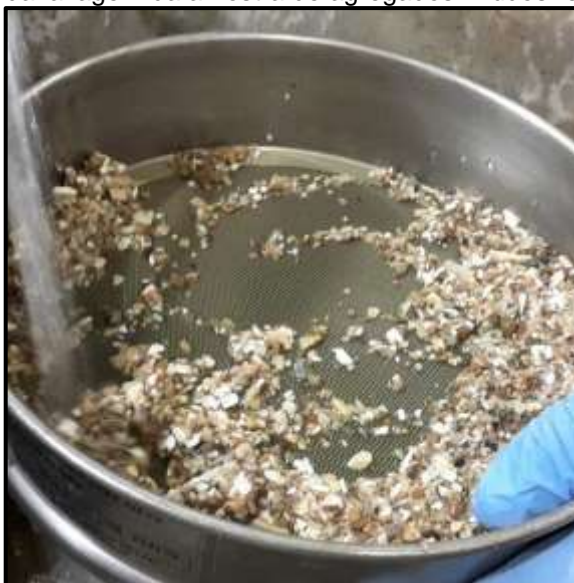
Figura 60 – Fotografia da lavagem da amostra de agregados miúdos reciclados.
