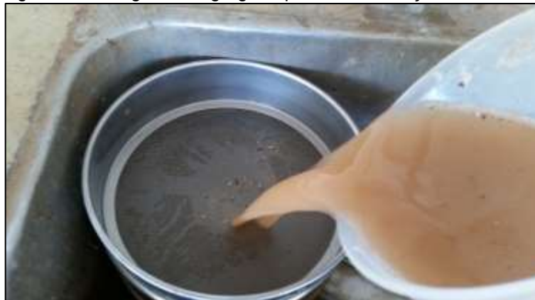
Figura 58 – Fotografia da lavagem do agregado para determinação do teor de material fino.
