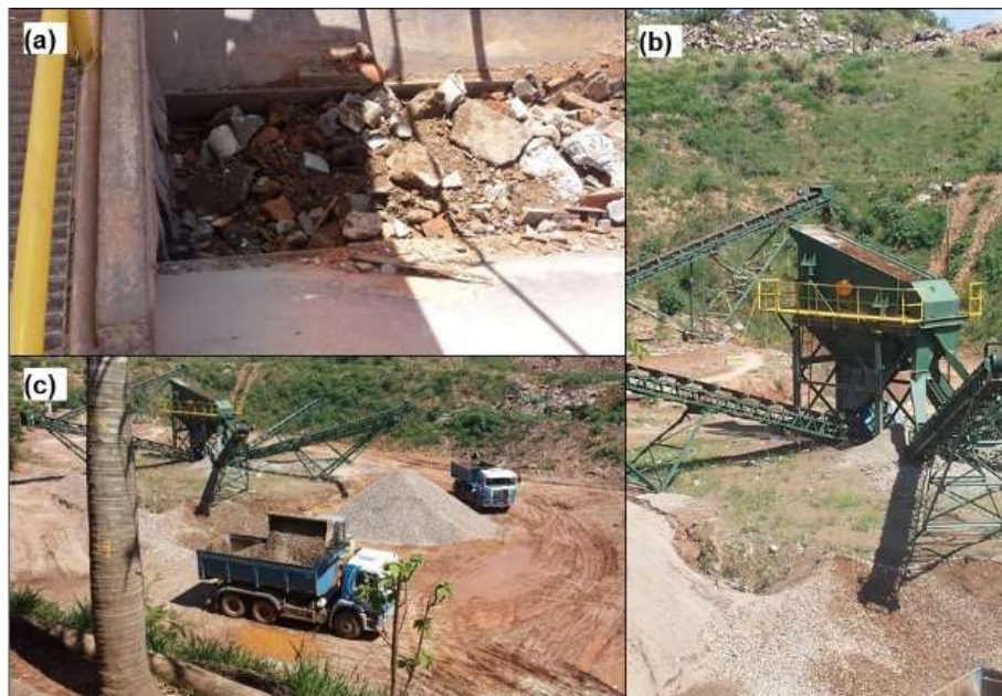
Figura 15 – Fotografias da usina recicladora municipal de Campinas – SP: (a) vista do abastecimento do britador; (b) geral do classificador e (c) geral do armazenamento e carregamento de agregado reciclado.
