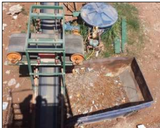
Figura 5 – Fotografia da separação de material metálico na usina recicladora municipal de Campinas/SP.
