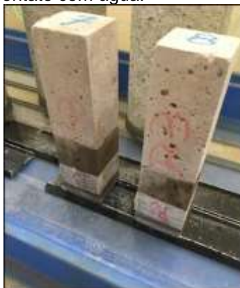
Figura 69 – Fotografia do ensaio para absorção de água por capilaridade: corpos de prova apresentando a face quadrada em contato com água.
