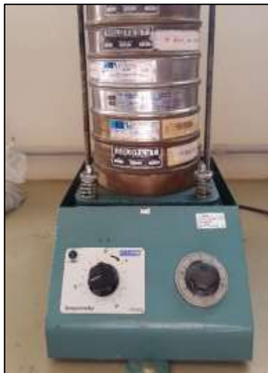
Figura 57 – Fotografia do agitador eletromecânico e série de peneiras para determinação da composição granulométrica.
