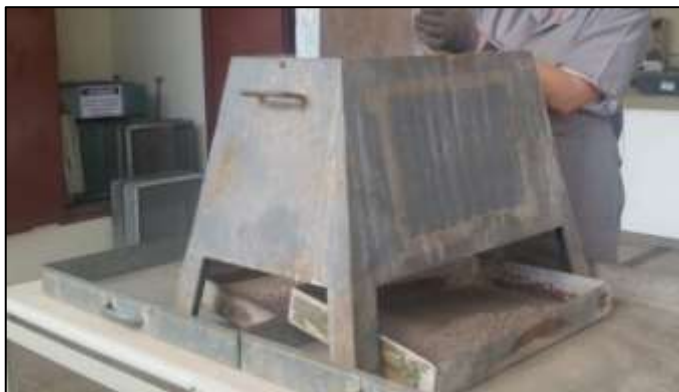
Figura 56 – Fotografia do quarteador mecânico utilizado no processo de redução das amostras de campo.
