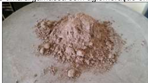
Figura 42 – Fotografia de uma argamassa sem aglomeração entre as partículas.
