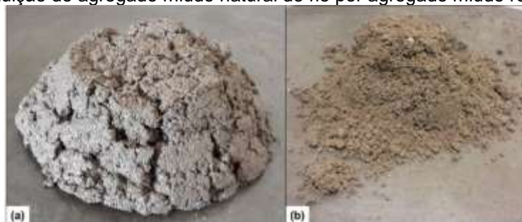
Figura 40 – Fotografia da consistência da argamassa: (a) argamassa referência; (b) argamassa com 40% de substituição do agregado miúdo natural de rio por agregado miúdo reciclado.
