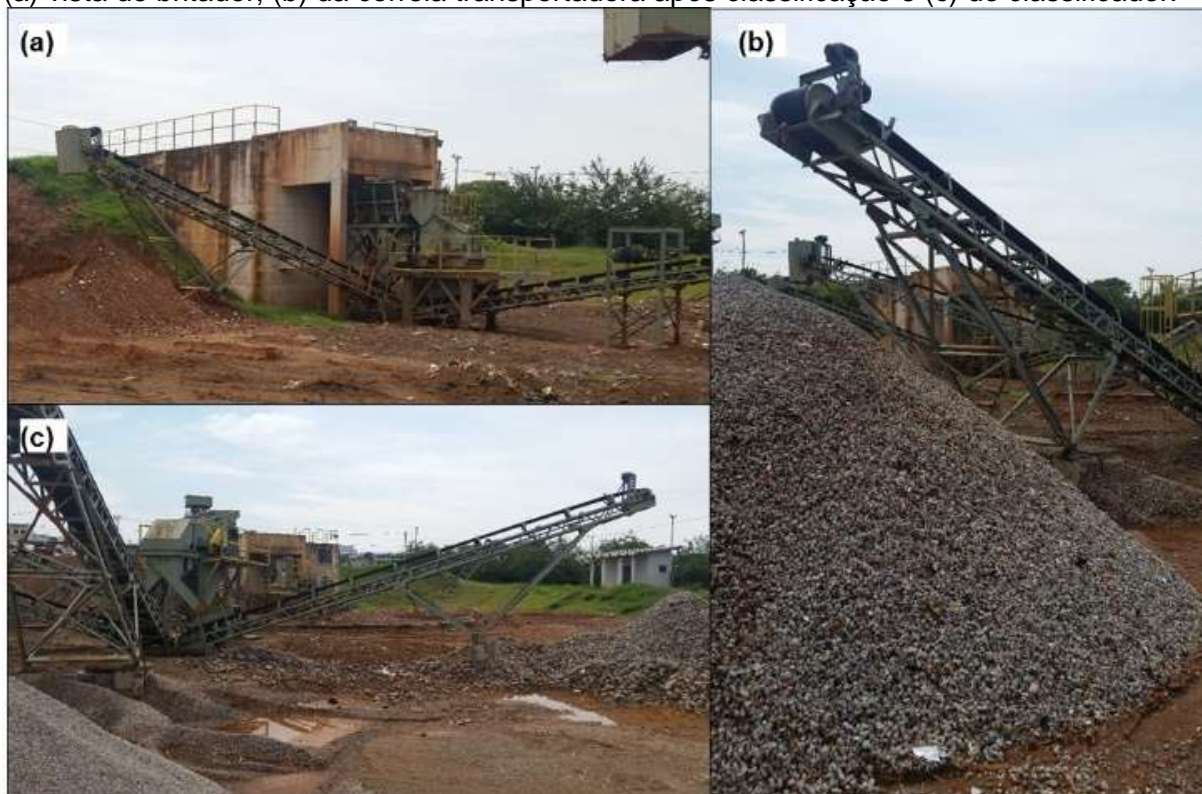
Figura 17 – Fotografias da usina recicladora de parceria público-privada de Hortolândia – SP: (a) vista do britador; (b) da correia transportadora após classificação e (c) do classificador.
