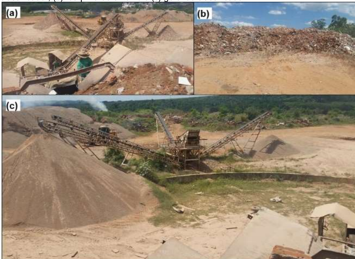
Figura 14 – Fotografias da usina recicladora privada de Americana – SP: (a) vista do abastecimento do britador e correia transportadora do material processado para o classificador; (b) da pilha de entulho e (c) geral do classificador.
