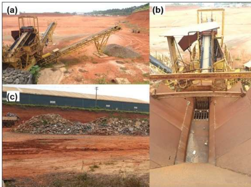
Figura 18 – Fotografias da usina recicladora privada de Paulínia – SP: (a) vista da correia transportadora após classificação; (b) do britador e (c) do material estocado para processamento.
