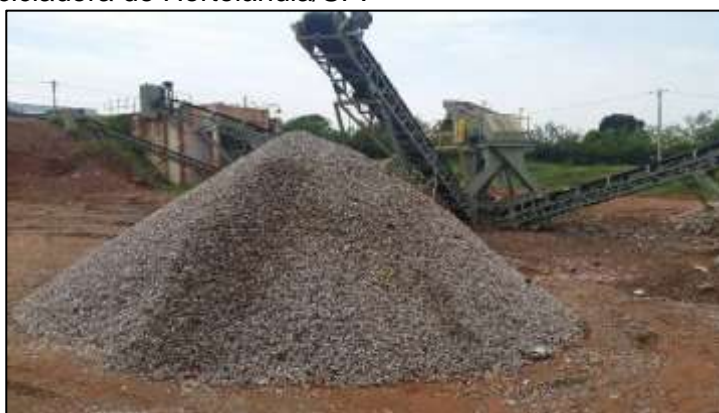
Figura 6 – Fotografia do classificador e esteiras de transporte com deposição de material britado na usina recicladora de Hortolândia/SP.
