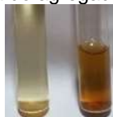
Figura 29 – Fotografias dos resultados obtidos nos ensaios de impurezas orgânicas, com o padrão à esquerda e a amostra à direita do agregado miúdo natural de rio.
