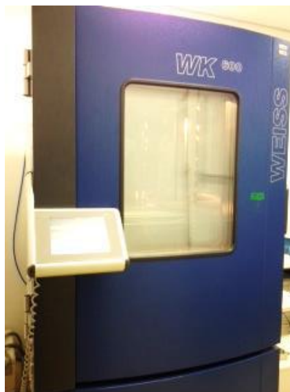
Figura 19. Foto da câmara climática, vista externa.
