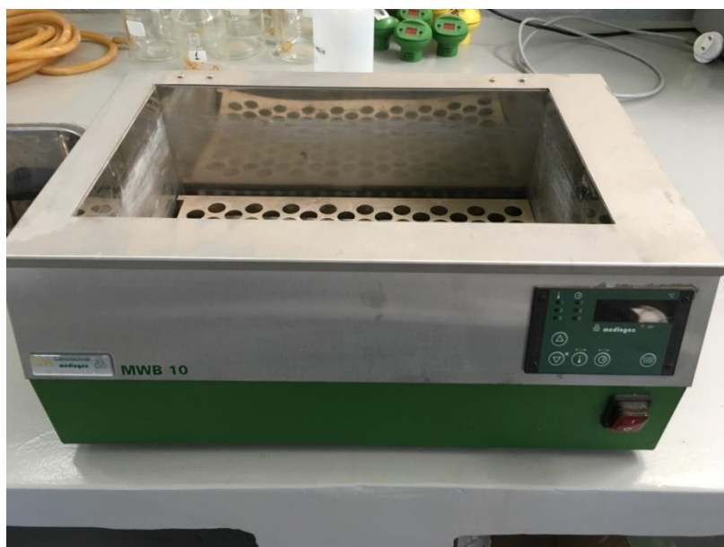
Figura 16 - Imagem do equipamento de banho maria utilizado no ensaio.
