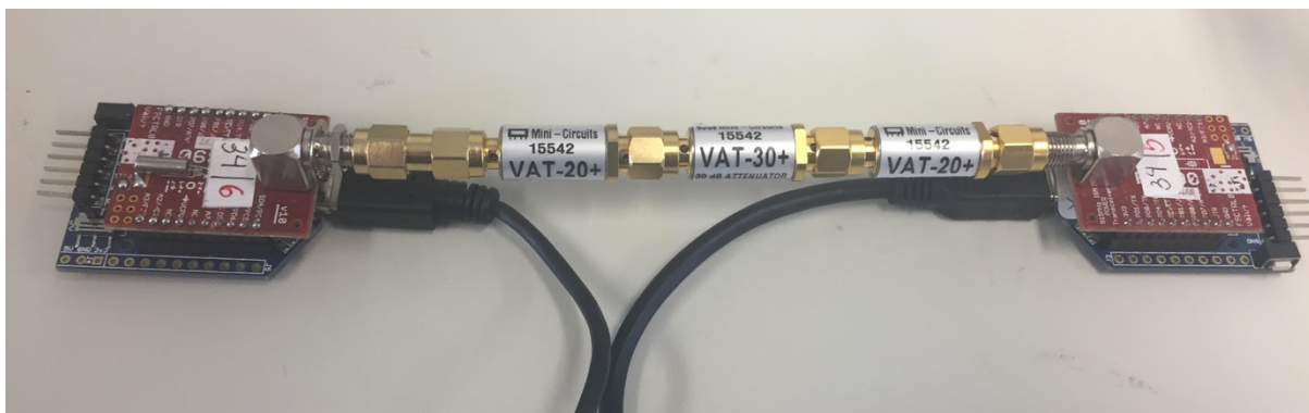
Figura 24 – Módulos de comunicação conectados por atenuadores
