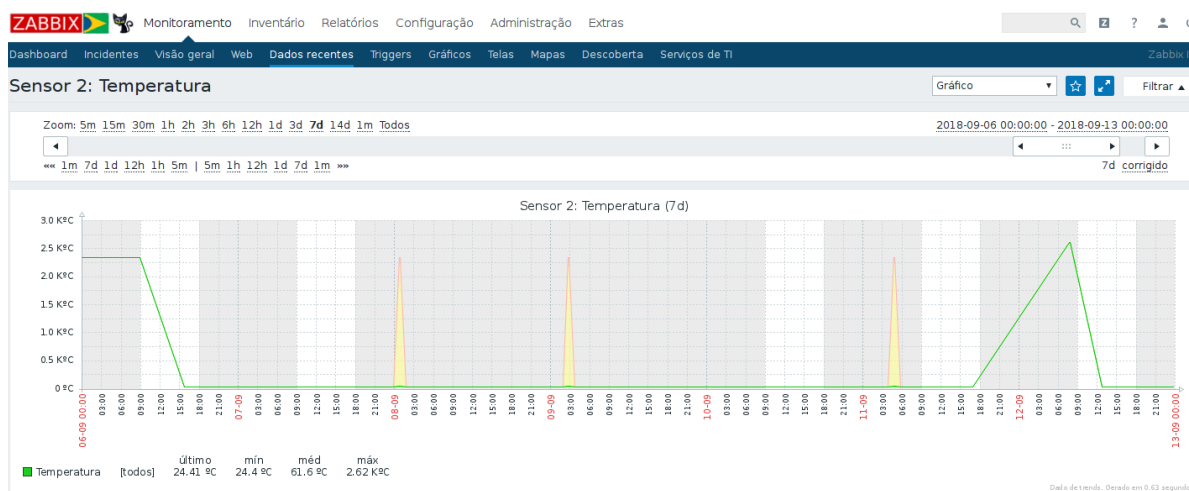
Gráfico 14 – Temperatura do Nó Sensor 2, no Teste 3, com outliers .
