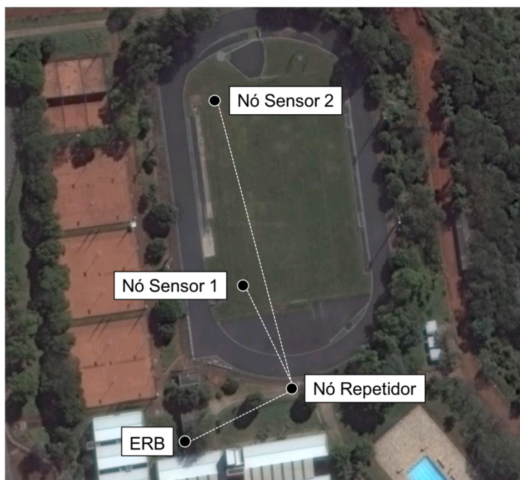
Figura 32 – Posicionamento dos elementos da rede no Teste 2.
