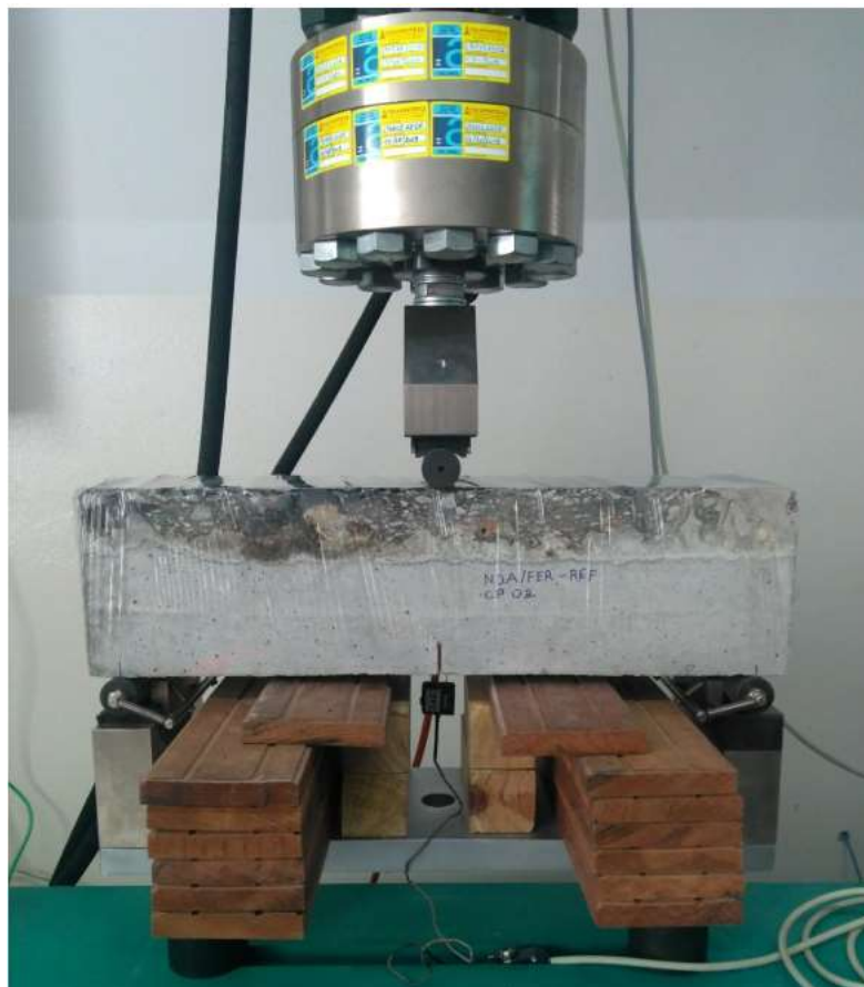
Figura 53 – Corpo de prova preparado para o início do ensaio de resistência residual à tração na flexão da viga composta
