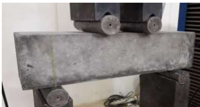
Figura 42 – Ensaio de resistência à tração na flexão.
