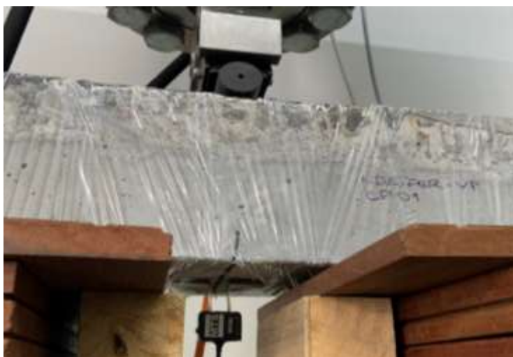
Figura 30 – “Clip gauge” posicionado nas placas de metal para o ensaio da EN 14651/2007
