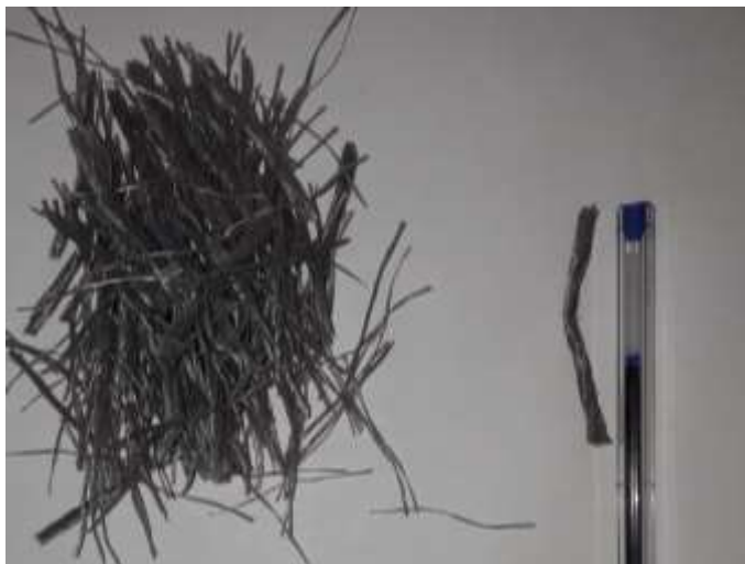
Figura 26 – Fibra FORTA FERRO® 38mm.
