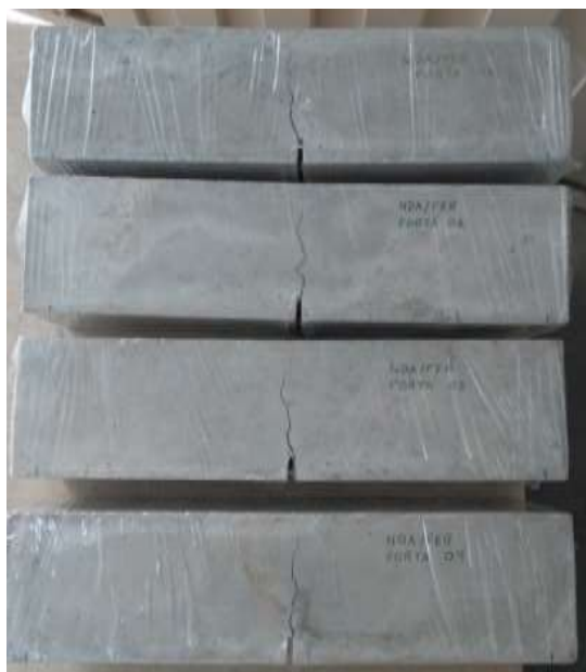
Figura 49 – Exemplo do aspecto de ruptura dos corpos de prova ensaiados
