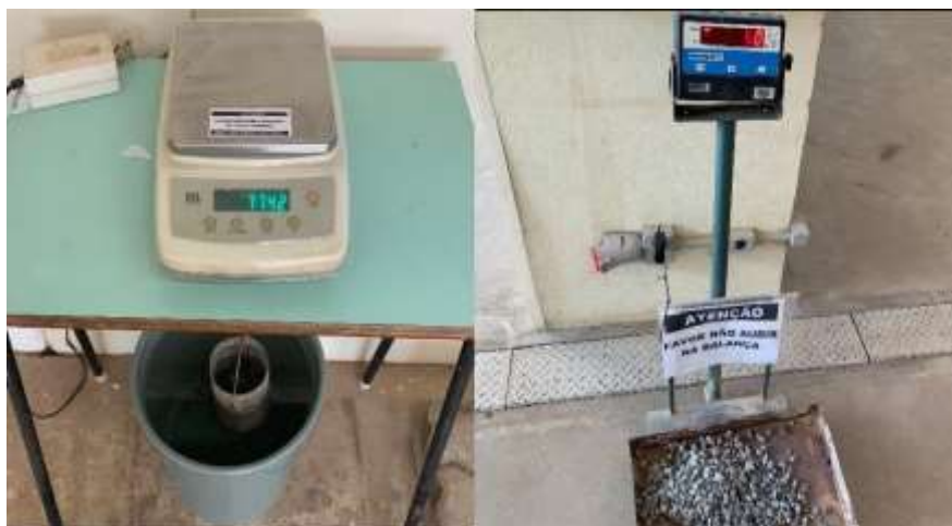
Figura 23 – a. Ensaio de determinação da massa específica; b. Pesagem do agregado graúdo
