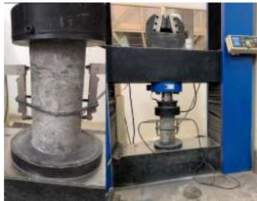
Figura 39 – Ensaio do módulo de elasticidade.
