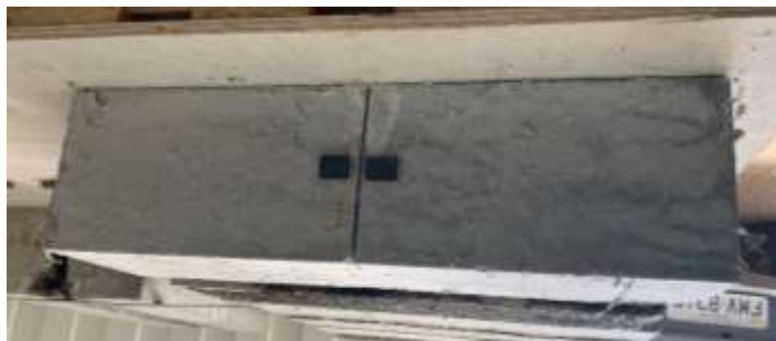
Figura 29 – Preparação da viga para o ensaio da EN 14651/2007
