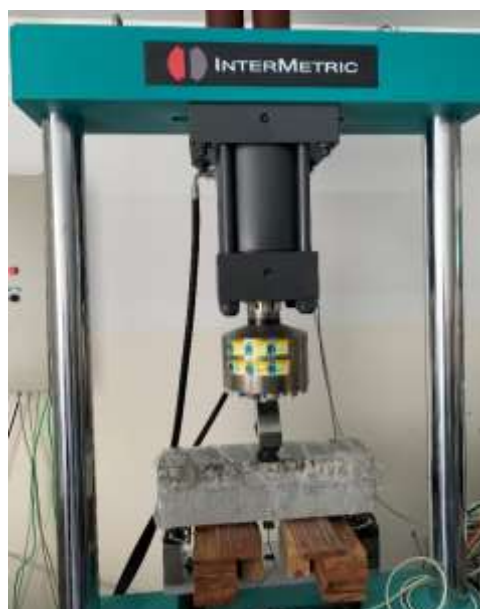
Figura 31 – Parte inicial do ensaio da EN 14651/2007
