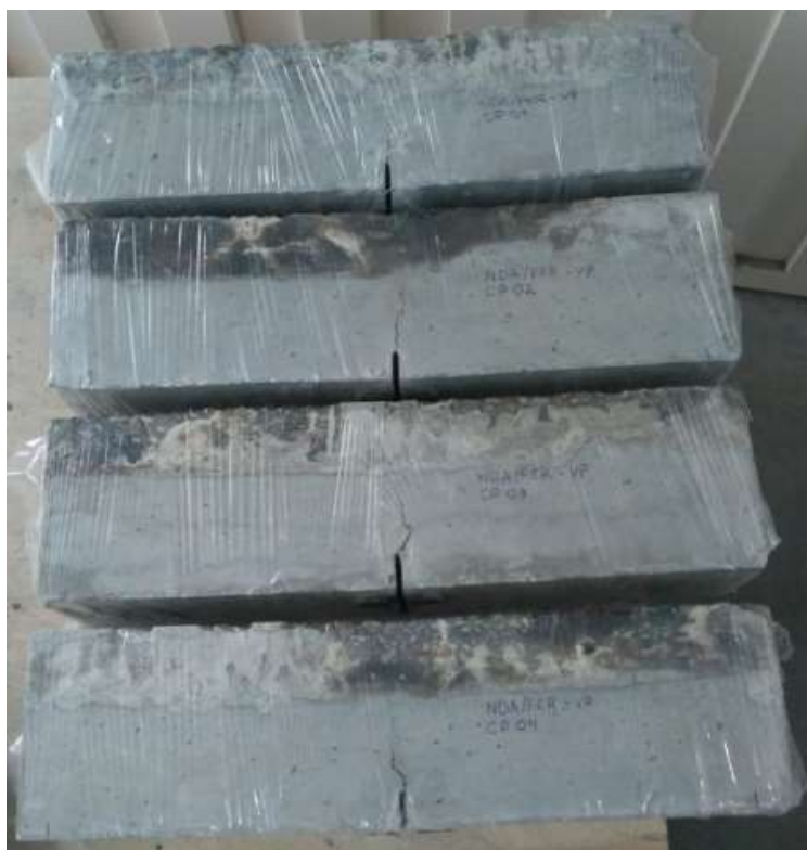
Figura 60 – Exemplo do aspecto de ruptura dos corpos de prova ensaiados
