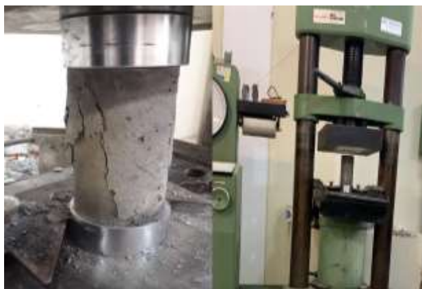
Figura 37 – Resistência à compressão - concreto referência e com adição de fibras sintéticas
