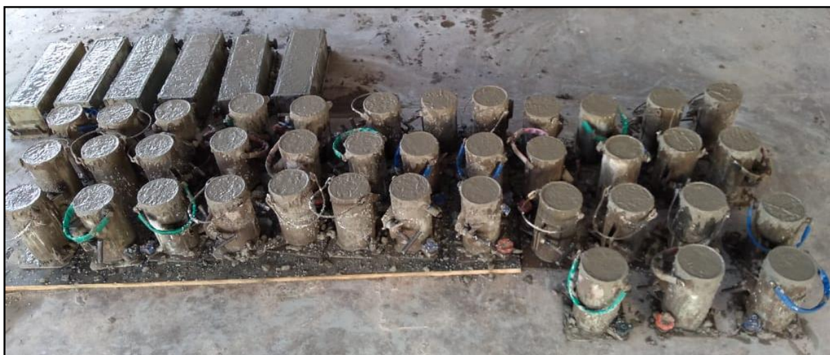
Figura 24. Moldagem dos corpos de prova do concreto C20.
