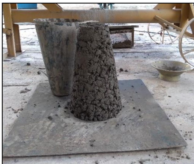
Figura 32. Ensaio do abatimento do tronco de cone de Abrams do C40.
