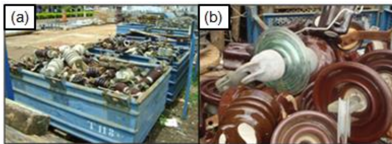
Figura 11. (a) Armazenamento de isoladores de porcelana na Estação Avançada; (b) Detalhe do isolador.
