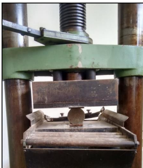
Figura 34. Ensaio de resistência à tração por compressão diametral.
