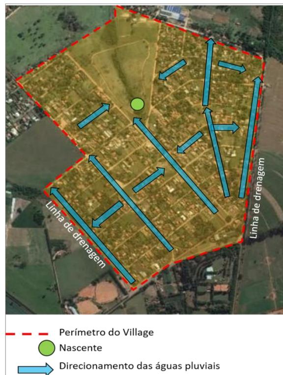
Figura 17: Esquema de fluxos de águas pluviais
