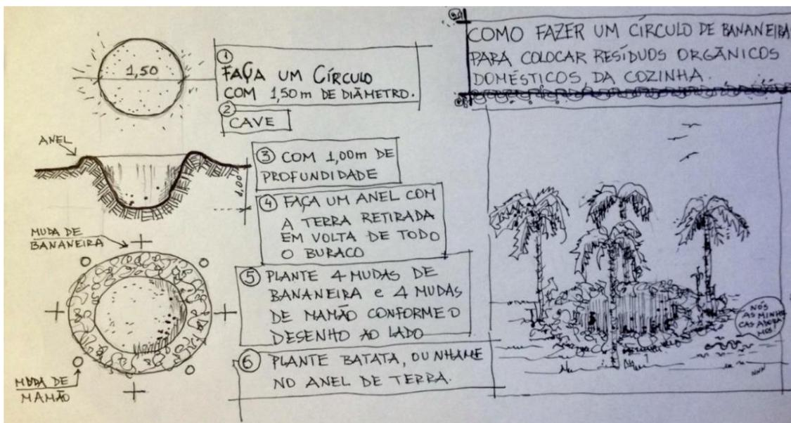
Figura 24: Construção de um círculo de bananeiras
