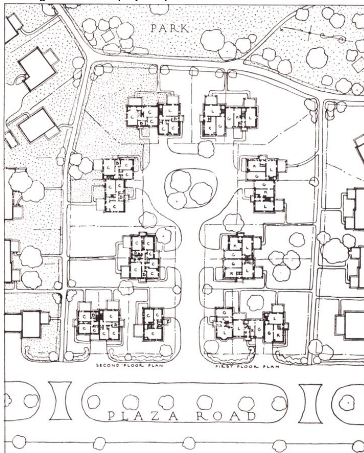
Figura 57: Plano no qual é mostrado o uso de espaçosos cul-de-sac em Radburn, com acesso através de uma via igualmente espaçosa para facilitar o deslocamento dos veículos locais.
