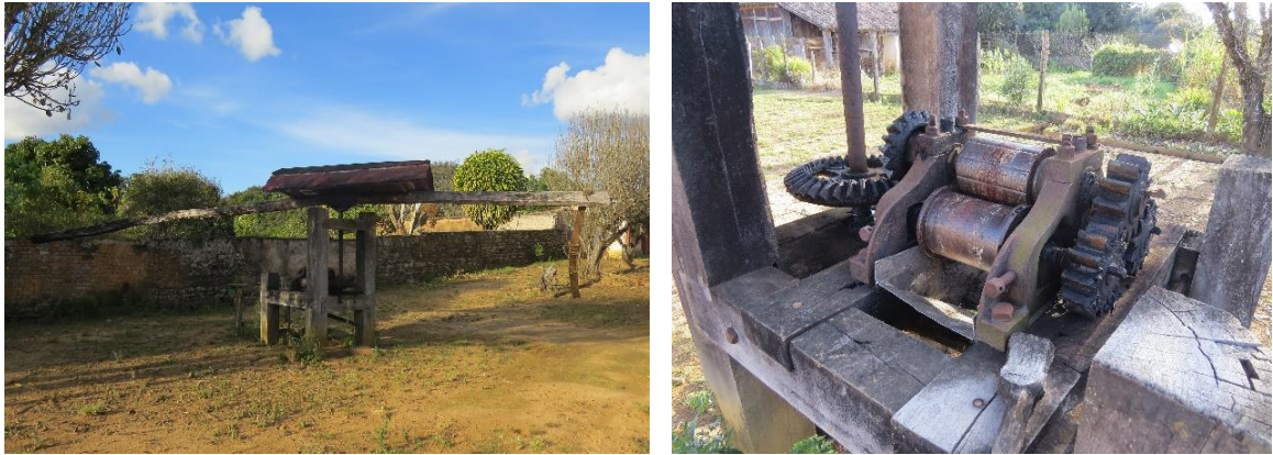
Figura 43: Engenho de tração animal na Fazenda Pitangueiras, em São Vicente de Minas, detalhe da máquina de moagem de cana. Fonte: Foto de Larissa S. Pereira. Acervo da pesquisa (2016).
