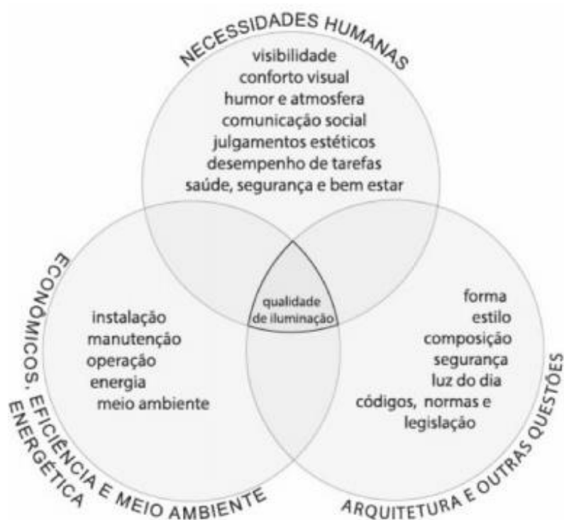
Figura 9 - Qualidade de iluminação: interseção das necessidades humanas, aspectos econômicos e ambientais, arquitetura e outras questões. Fonte: (IESNA, 2008, apud Almeida, 2017, p.241).
