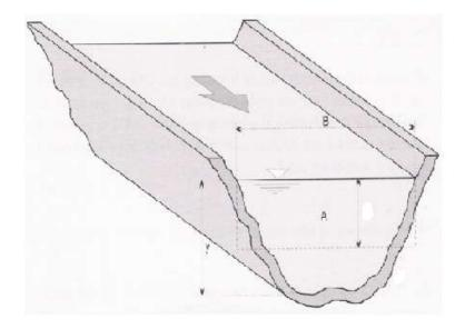
Ilustração 3.2. Perfil transversal de canal para análise de vazão
